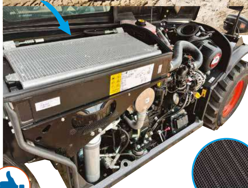
MICROGRIGLIA ONDULATA La griglia d'aspirazione a maglia finissima non lascia entrare impurità e il profilo ondulato della griglia scongiura l'adesione di elementi esterni come le foglie.
