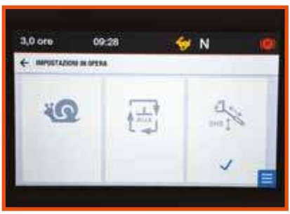
IMPOSTAZIONI Si possono attivare le principali funzioni. Tra queste anche la gestione dello Smart Handling System.
