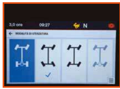
TRE MODALITÀ Si può impostare la sterzata delle ruote anteriori, quella concentrica o quella a granchio.
