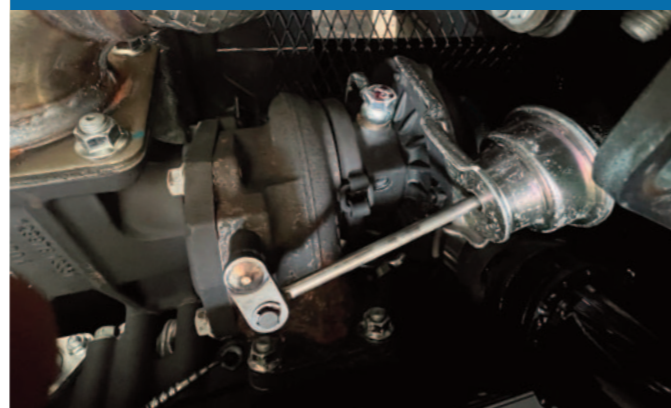
Turbo con wastegate - evita sovrappressioni
