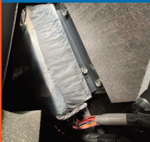
Centralina ECU lontana da fonti di calore
