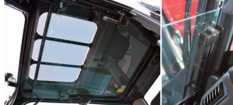
Parabrezza apribile con porzione inferiore a pacchetto
