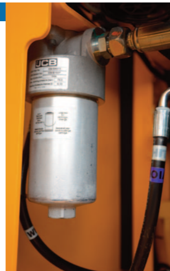
PILOTAGGI Sopra la pompa pilotaggi KPM e sotto il relativo filtro (10 micron), molto ben accessibile da terra.
