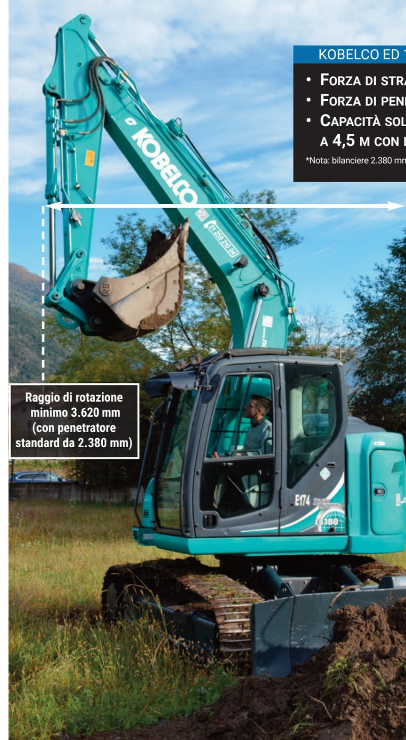
Raggio di rotazione minimo 3.620 mm (con penetratore standard da 2.380 mm)
