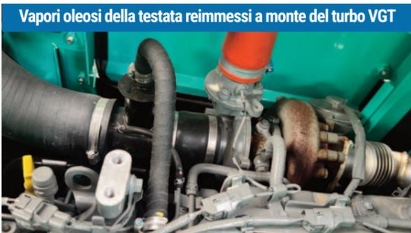
Vapori oleosi della testata reimmessi a monte del turbo VGT
