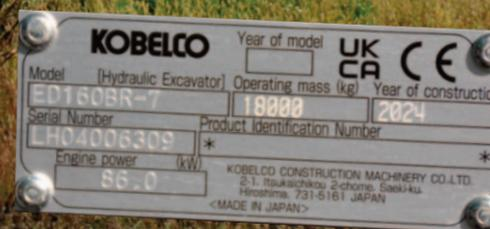
**BEN 18.000 KG** A sinistra la targhetta di una macchina con zavorra da 1.000 kg montata da stabilimento. Eventualmente le zavorre si possono ordinare in seguito.
