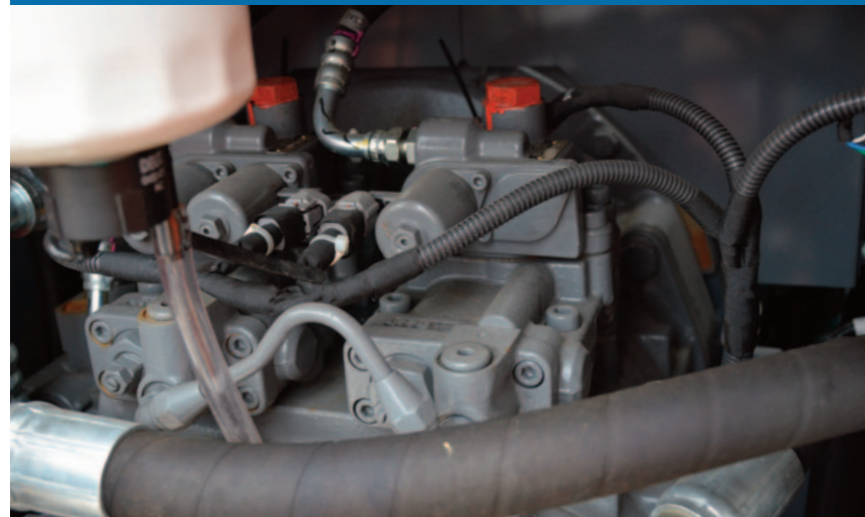
DISTRIBUTORE ACCESSIBILE Le linee di alimentazione senza giunti denotano l'attenzione maniacale all'efficienza idraulica.
