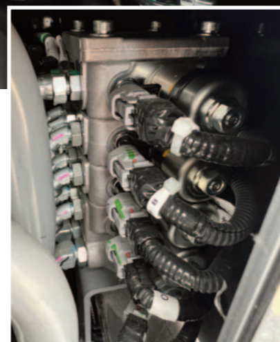
PROPORZIONALI Il blocco dei solenoidi dei comandi elettroproporzionali è davanti al distributore, ben accessibile.
