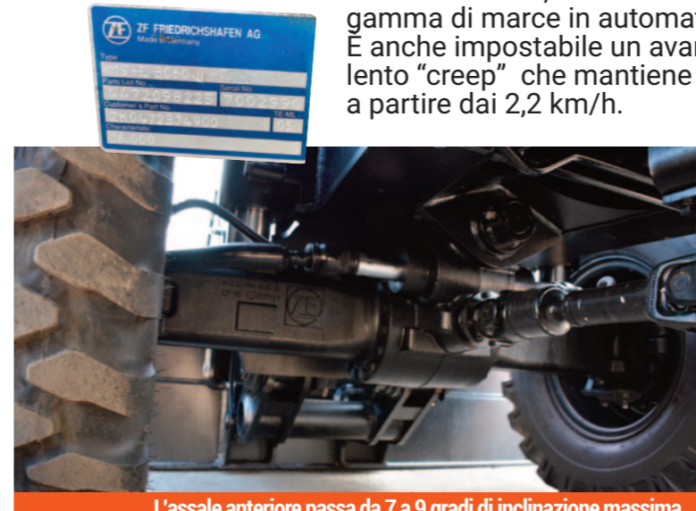
L'assale anteriore passa da 7 a 9 gradi di inclinazione massima
