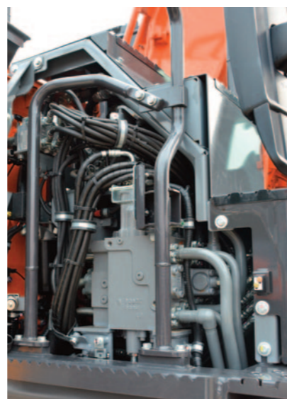
DISTRIBUTORE ACCESSIBILE Le linee di alimentazione senza giunti denotano l'attenzione maniacale all'efficienza idraulica.
