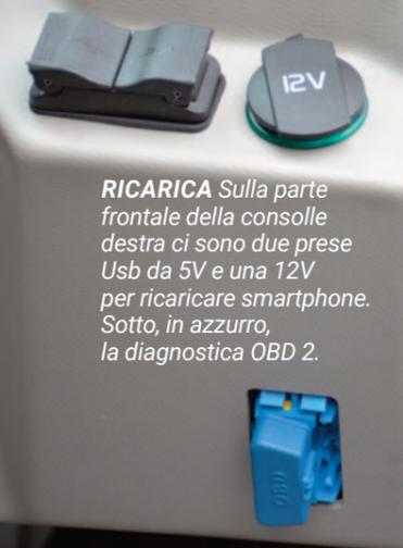
**RICARICA** Sulla parte frontale della consolle destra ci sono due prese Usb da 5V e una 12V per ricaricare smartphone. Sotto, in azzurro, la diagnostica OBD 2.
