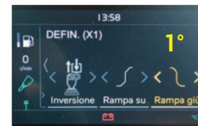
**REATTIVITÀ** Per le attrezzature idrauliche è possibile scegliere la reattività sia d'avvio, sia d'arresto.
