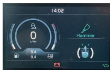
**HOME** La pagina iniziale indica il regime motore, il livello gasolio, la temperatura refrigerante e attrezzatura idraulica.
