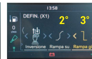
**TRE RAMPE** La reattività di risposta delle linee idrauliche si regola tramite tre rampe pre impostate in avvio e arresto.
