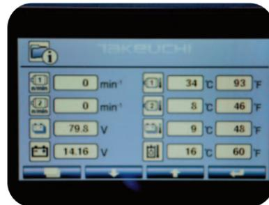
**SOTTO CONTROLLO** Da questa pagina, si monitorano: il regime dei motori, la loro temperatura o quella dell'olio idraulico. Si visualizza anche vortaggio e temperatura della batteria.
