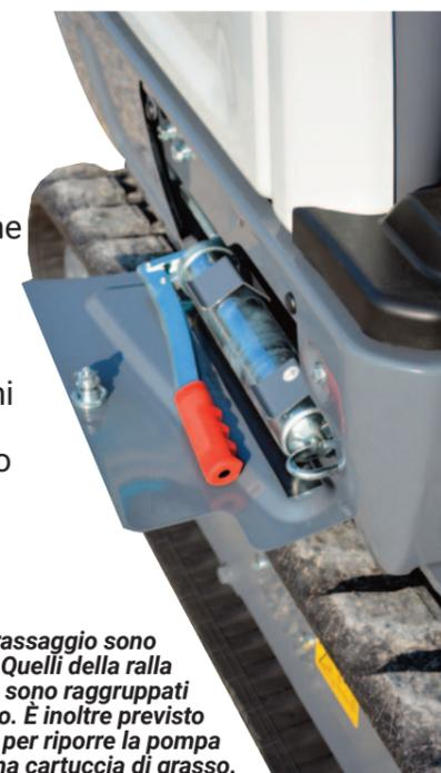
**NESSUNA SCUSA** Tutti i punti d'ingrassaggio sono messi in evidenza e ben protetti. Quelli della ralla e del fondo del cilindro di brandeggio sono raggruppati sulla torretta, a destra del braccio. È inoltre previsto un vano sul lato destro della torretta per riporre la pompa d'ingrassaggio e una cartuccia di grasso.
