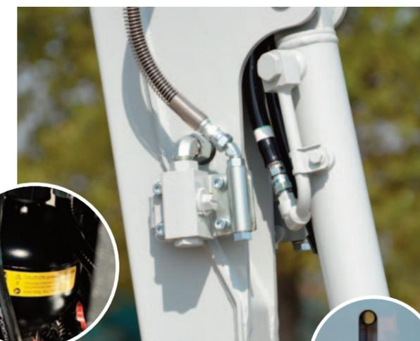
**QUALITÀ TOP** L'accumulatore di pressione della tedesca Hydac che assorbe sovrappressioni allungando la vita dell'impianto, assicura una silenziosità di funzionamento delle pompe e permette manovre di rientro in caso di avarie.
