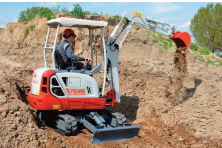
L'idraulica è semplice, ben collaudata, senza gestione elettronica. I componenti sono di qualità made in Japan
