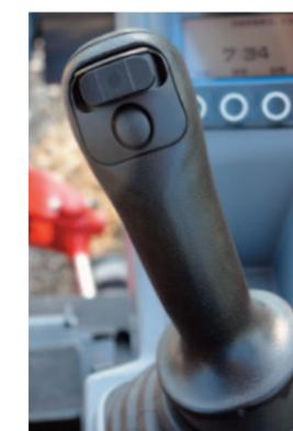
**AUX 1 PROPORZIONALE** La prima linea idraulica ausiliaria, di serie già dall'allestimento d'accesso Easy, è a controllo proporzionale con trimmer in testa al manipolatore. Da notare la distanza tra le teste dei due manipolatori che è di bel 540 mm, come fosse un modello più grande. È un accorgimento da non ritenersi scontato per un mini giapponese da 2 t di peso operativo.
