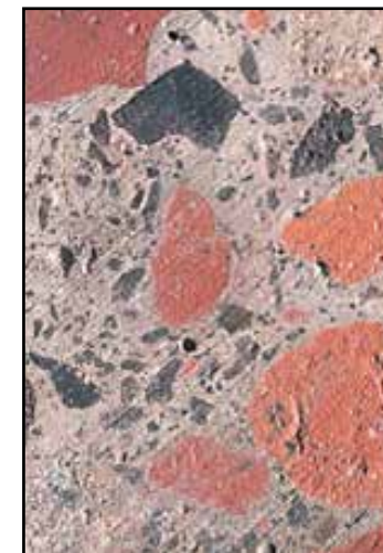
Miscuglio di calcestruzzo e muratura frantumati
