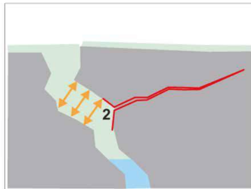
2 - in caso di gelo sotterraneo : squamatura ('scaling')
