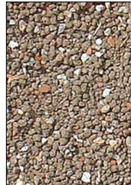
'sabbie di frantumazione' (differenti 'nature mineralogiche': calcari, arenarie, porfidi, ...)
