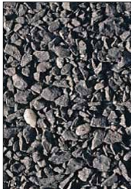
'sabbie di frantumazione' (differenti 'nature mineralogiche': calcari, arenarie, porfidi, ...)
