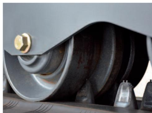
**RULLI TRIPLA FLANGIA** Il sottocarro conta 4 rulli d'appoggio larghi 100 mm, che appoggiano su cingoli da 450 mm. Complessivamente la larghezza massima di trasporto è di 1.930 mm.
