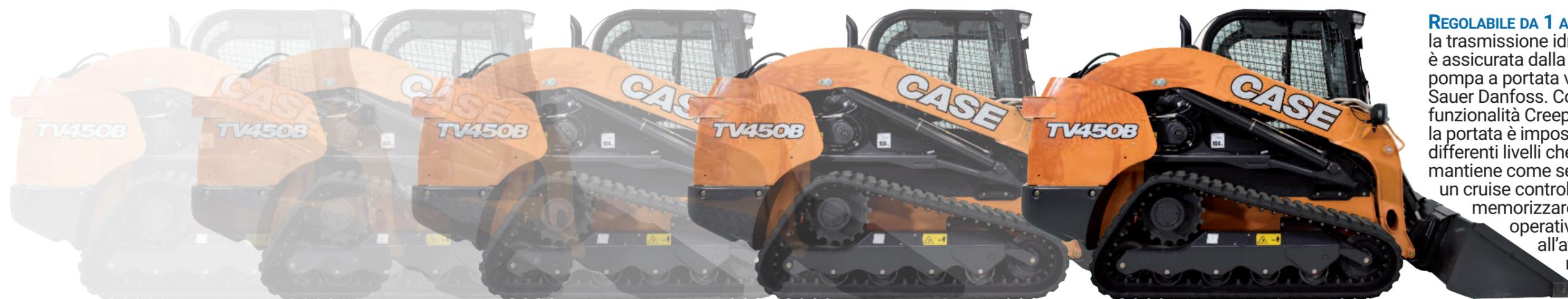
**REGOLABILE DA 1 A 100%** la trasmissione idraulica è assicurata dalla doppia pompa a portata variabile Sauer Danfoss. Con la funzionalità Creep Speed la portata è impostabile in 100 differenti livelli che lo skid mantiene come se avesse un cruise control. Si possono memorizzare le velocità operative in base all'attrezzatura montata.
