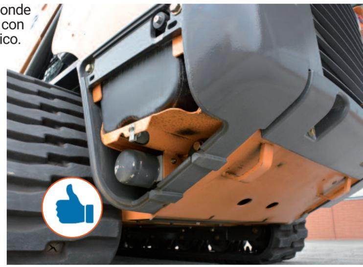
**ZAVORRA INTELLIGENTE** Rispetto al TV370B, il TV450 monta una zavorra posteriore in tre pezzi: due cantonali e un modulo centrale. Il cantonale sinistro include uno sportello per accedere al filtro dell'olio motore remoto e al microfiltro alla base del serbatoio dell'urea. Questo permette di velocizzare la manutenzione ordinaria.
