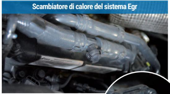
Scambiatore di calore del sistema Egr
