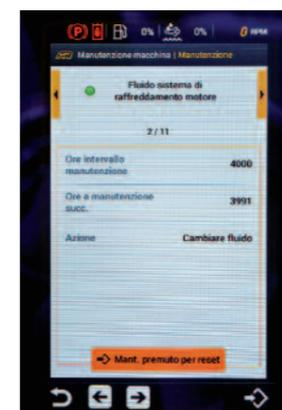
**COUNTDOWN** Se l'olio motore si cambia a 500 ore, il liquido refrigerante ogni 4.000 ore e l'olio della trasmissione ogni 500 ore
