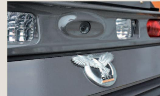
**SUPER PROTETTA** La retrocamera ad alta risoluzione è perfettamente integrata nel cofano. Non è esposta a urti e intemperie. L'immagine sul monitor si può impostare fissa o solo in caso di retromarcia. La grafica distanziometrica si può disattivare.
