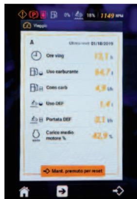
**PARZIALI DETTAGLIATI** I contatore resettabili memorizzano anche i dati di consumo carburante e urea, nonché il carico medio del motore termico.
