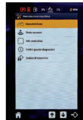
**MANUTENZIONE** Sopra, la schermata che riassume tutti i parametri di controllo del TV450B. Il sistema segnala lo stato dei sensori e loro malfunzionamenti
