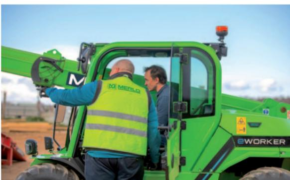
**VETRO E GANGIO TRAINO** Sopra la versione cabina dell'eWorker con i due vetri sul lato sinistro. Sotto un eWorker allestito con gancio traino. Se il 2WD ha una capacità di tiro di 2.000 kg, il 4WD di ben 3.000 kg.
