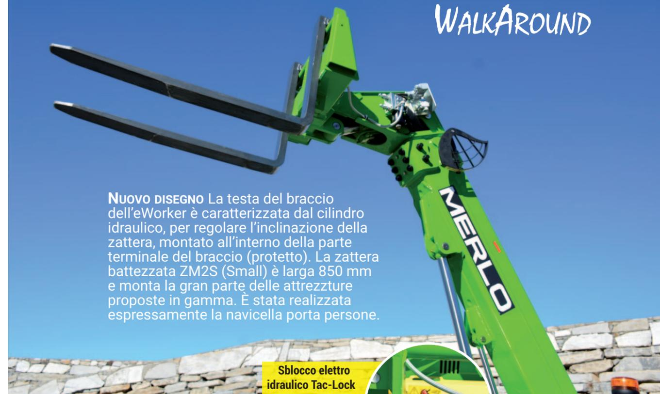
**NUOVO DISEGNO** La testa del braccio dell'eWorker è caratterizzata dal cilindro idraulico, per regolare l'inclinazione della zattera, montato all'interno della parte terminale del braccio (protetto). La zattera battezzata ZM2S (Small) è larga 850 mm e monta la gran parte delle attrezzature proposte in gamma. È stata realizzata espressamente la navicella porta persone.
