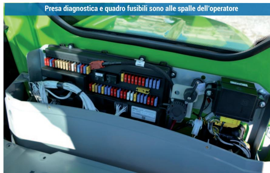
Presca diagnostica e quadro fusibili sono alle spalle dell'operatore
