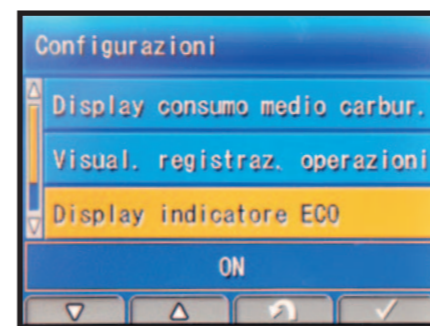
INDICATORE CONSUMO L'operatore può scegliere se visualizzare o meno gli strumenti a display. Per quanto riguarda il consumo carburante può scegliere tra indicatore istantaneo o medio.
