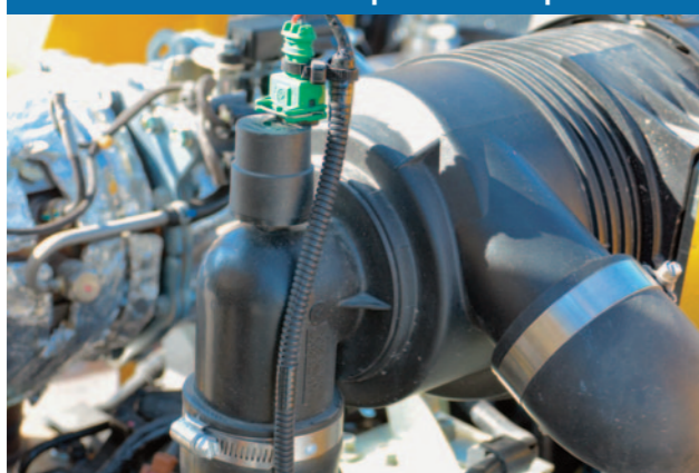
L'elettronica controlla la quantità d'aria aspirata
