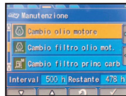
LONG LIFE Come per la maggioranza delle macchine compatte construction, anche l'SK715-8 prevede il cambio dell'olio motore e relativo filtro ogni 500 ore operative. Meno fermo macchina.
