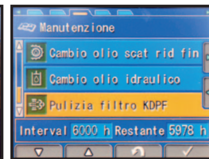
OGNI 6.000 ORE La pulizia del filtro antiparticolato è da prevedere ogni seimila ore. Su uno skid è un intervallo elevato e l'affidabilità della tecnologia Yanmar è comprovata da anni di utilizzo.
