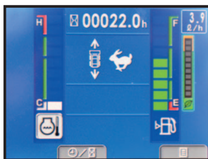
A MOTORE AVVIATO Una volta acceso il motore la home page segnala il tipo di marcia selezionata (qui lepre/veloce), le ore operative (oppure l'ora) e si aggiorna il livello del carburante.
