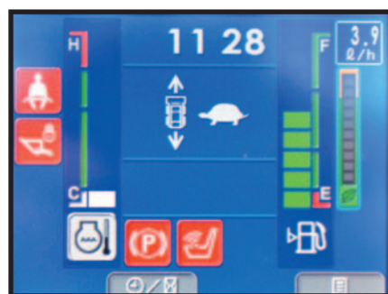
CONCENTRATO DI INFO La home page della nuova interfaccia operatore è completissima. In rosso le icone durante il check che avviene mettendo il contatto. C'è l'alert cintura di sicurezza.
