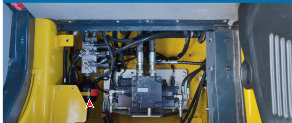
Accumulatore di pressione per scarico delle linee Aux e abbassamento braccio a motore spento
