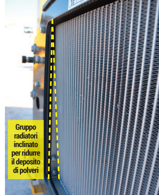
LA SUPERFICIE RADIANTE AUMENTATA DI 44 MM IL LARGHEZZA E 50 MM IN ALTEZZA
