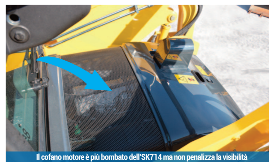
LA SUPERFICIE RADIANTE AUMENTATA DI 44 MM IL LARGHEZZA E 50 MM IN ALTEZZA
