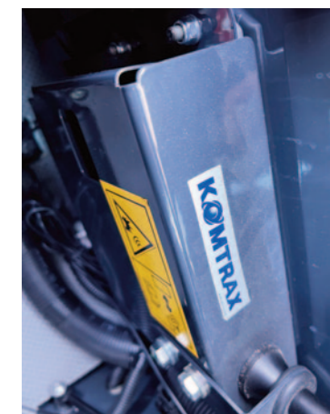
PROTETTA La centralina Komtrax è al sicuro, in cabina.
