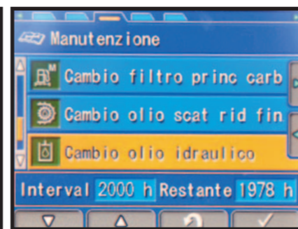
OLIO IDRAULICO OGNI 2000 Tra gli intervalli a sistema abbiamo notato il cambio dell'olio idraulico indicato a 2.000 ore, anche grazie ad un filtro sul ritorno della Aux al serbatoio.
