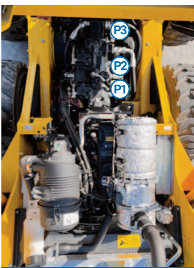
Motore longitudinale e pompe in serie
