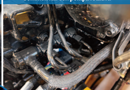
Common rail con pompa rotativa
