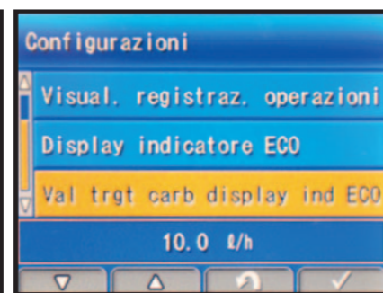
INDICATORE ECO A monitor si può impostare un indicatore a 10 livelli che indica il consumo istantaneo. In questo modo l'operatore può migliorare i suoi consumi parzializzando l'acceleratore.
