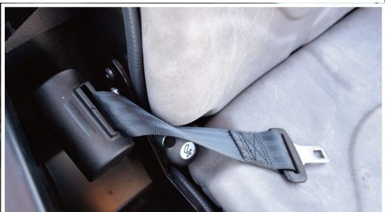
CINTURA AUTOAVVOLGENTE Perfetta nel caso in cui la macchina viene utilizzata da più operatori.
