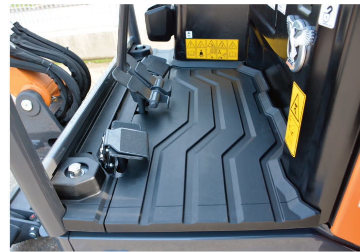
A destra i pedali della traslazione ripiegabili per chi preferisce utilizzare le leve.
