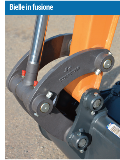
Struttura avbraccio realizzata per piegatura
