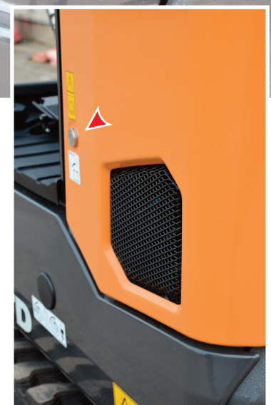
POMPE AERATE E ACCESSIBILI Sopra, il cofano sinistro con griglia che permette di estrarre calore dal vano pompe. Il cofano si apre con la semplice chiave d'accensione, soluzione più unica che rara.
