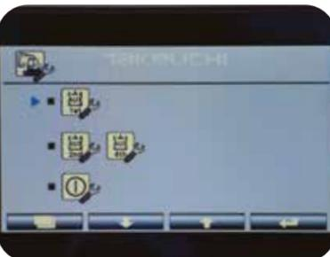
**UNA AD UNA** Da questa schermata è possibile attivare ciascuna delle tre linee Aux e regolarne la portata litro per litro, accedendo al sottomenu. Anche i più esperti sono soddisfatti.
