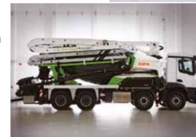
braccio da 36 m in cinque sezioni di cui l'ultima ruotabile in continuo di 360 gradi. La lettera L nella sigla indica l'appartenenza alla linea Steeltech nota per l'elevata qualità e la
