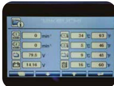
**SOTTO CONTROLLO** Da questa pagina, si monitorano: il regime dei motori, la loro temperatura o quella dell'olio idraulico. Si visualizza anche vortaggio e temperatura della batteria.
