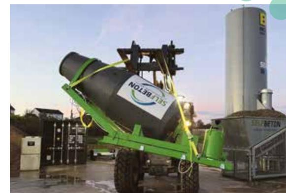
struzzo in piccoli cantieri o in cantieri difficili accesso, la E-Selftpupie elettrica ha un'autonomia di funzionamento di ben otto ore. Selfbeton presenta E-Selftpupie come una soluzione per ridurre l'inquinamento acustico associato alla produzione di piccole quantità di calcestruzzo in cantiere.
