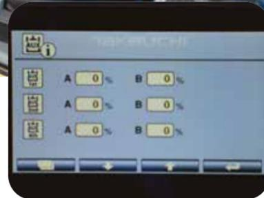
**PORTATE AUX REGOLABILI** Tramite l'elettronica è possibile regolare la portata di mandata e ritorno di tutte le tre linee Aux di serie.
