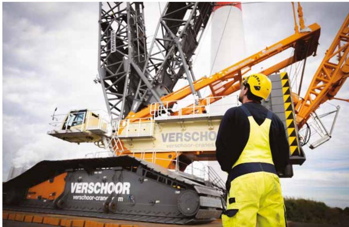
Verschoor ha scelto la LR 11000era principalmente per la grande capacità di sollevamento ad altezze elevate, ma anche per la concezione di base che ne semplifica il trasporto riducendo la larghezza massima di trasporto fino a 3.500 mm, l'altezza di trasporto fino a 3.200 mm e contenendo il peso dei moduli macchina da trasportare.
