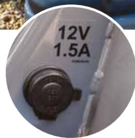
**PRESA 12V DI SERVIZIO** Alle spalle del sedile, protetta da un coperchio a molla, c'è una presa per ricaricare, ad esempio, uno smartphone.
