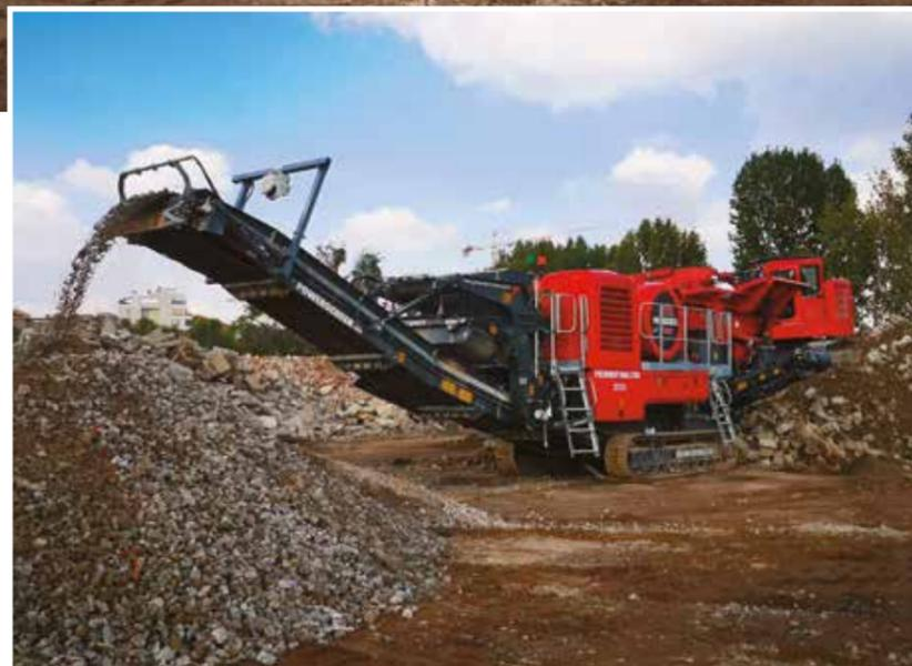
**PREMIERTRAK 330** La gamma Premiertrak di impianti di frantumazione primaria a mascelle della Powerscreen è composta da modelli per applicazioni minerarie, estrattive e di demolizione e riciclaggio. Il modello Premiertrak 330 fornito dalla Impianti Industriali è caratterizzato da un alimentatore a grizzly a doppio stadio. Asso nella manica di questo modello sono i tempi di messa in servizio rapidi e la velocità variabile del frantoio per massimizzare la produzione.
