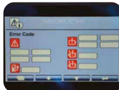
**DIAGNOSTICA** I codici errore sono suddivisi per tematica: batteria, alimentazione batteria, motore elettrico principale, motore elettrico secondario e sezione errori generici.
