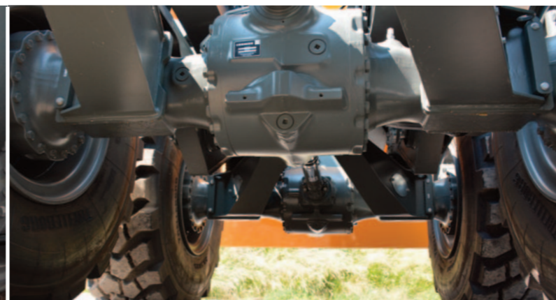
Secondo e terzo asse sono sempre degli ZF MT-D 3095 II
