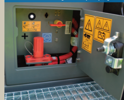
Avviamento d'emergenza e spia spurgo Scr
