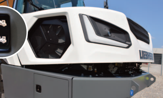
Cofano ad apertura elettro idraulica da cabina
