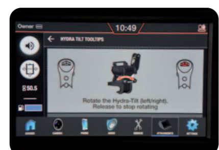
MULTIFUNZIONE SEMPLICE Il nuovo monitor semplifica molto la gestione delle funzioni idrauliche tramite una iconografia semplice e intuitiva.
