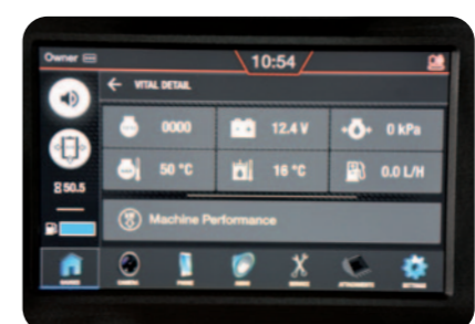
PRESSIONE E TEMPERATURA OLIO Tra i parametri rilevati dall'elettronica, anche la pressione, la temperatura dell'olio idraulico e il consumo medio.
