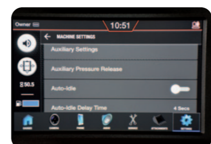
SI SPENGE DA SOLO Oltre al ritorno al regime minimo del motore regolabile, l'E55z permette di impostare lo spegnimento motore automatico.
