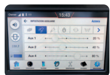
IDRAULICA AL CENTRO In base alla tipologia di attrezzatura idraulica selezionata, la macchina propone la regolazione del flusso delle linee aux.
