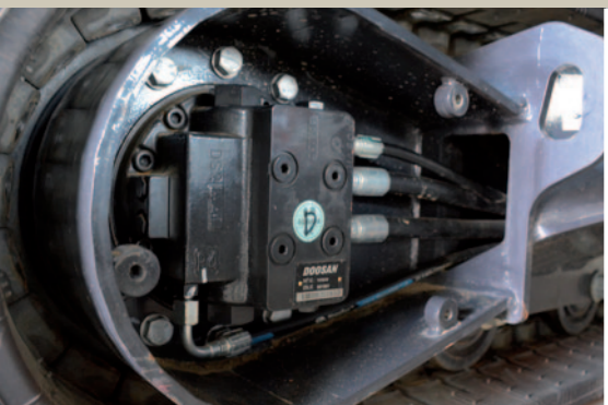
Motori Doosan a 2 velocità con scalo automatico
