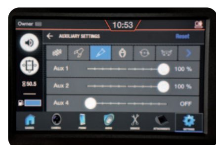
MARTELLO Selezionando la funzionalità martello la Aux 4 si disattiva e sul ritorno della Aux 1 si attiva il bypass per il ritorno del flusso al serbatoio.
