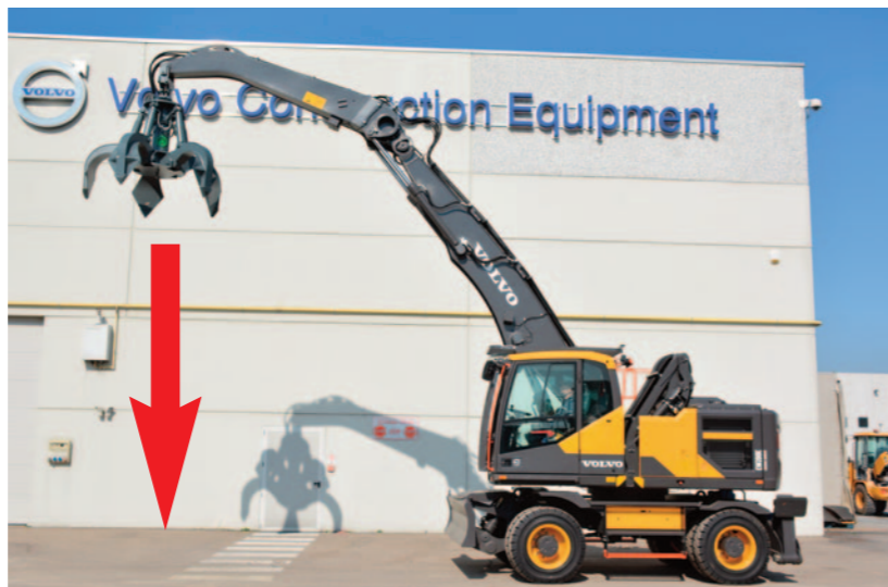
BRACCIO FLOTTANTE PER SFRUTTARE IL PESO ATTREZZATURA
