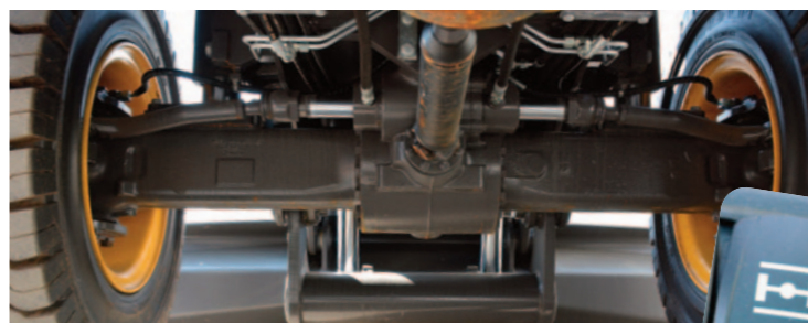
Assale anteriore oscillante con blocco manuale e automatico
