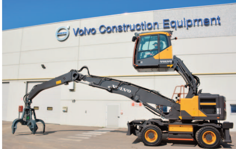
BRACCIO FLOTTANTE PER SFRUTTARE IL PESO ATTREZZATURA
