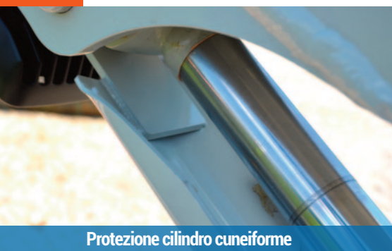
Protezione cilindro e valvola anticaduta braccio
