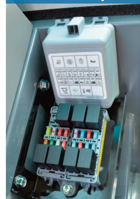
Quadro fusibili in cabina e con legenda a icone
