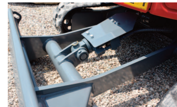
Cilindro con guarnizione anti polvere
