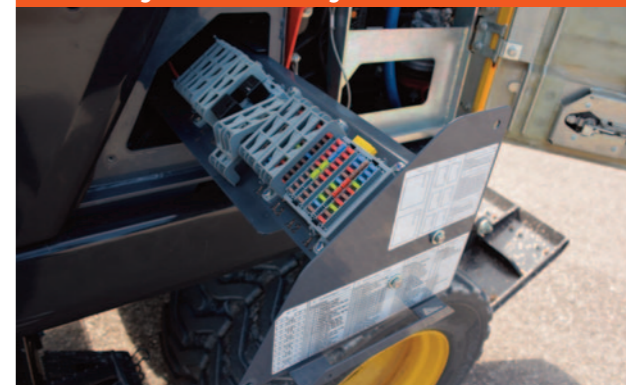
Fusibili raggruppati in cassetto accessibile da terra
