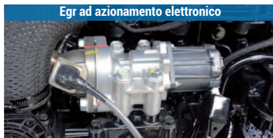
Egr ad azionamento elettronico
