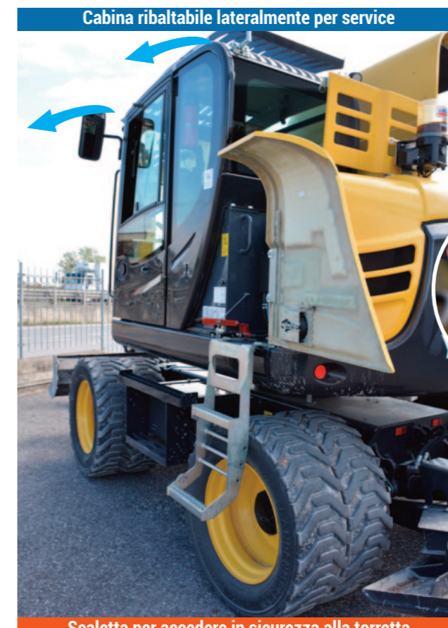
Scaletta per accedere in sicurezza alla torretta
