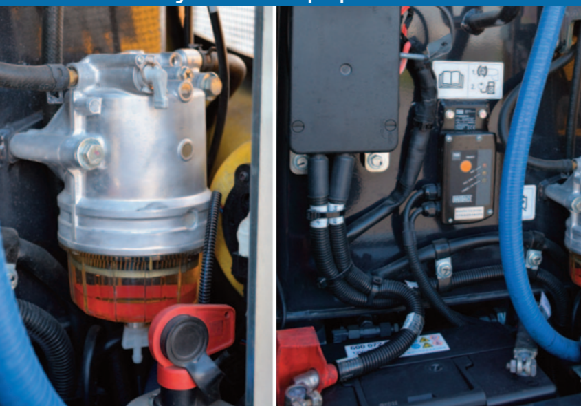
Reinnesco filtro gasolio elettrico e pompa rifornimento di serie
