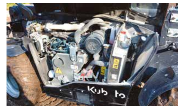
3 CILINDRI Sotto al cofano, manco a dirlo, c'è un motore Kubota turbo montato trasversalmente. Tra le opzioni anche la ventola reversibile.
