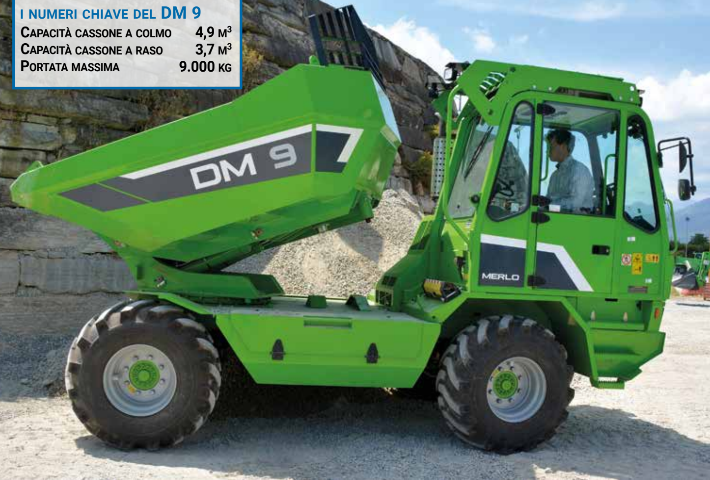
Il cassone ruota grazie a cilindro e biella di richiamo
