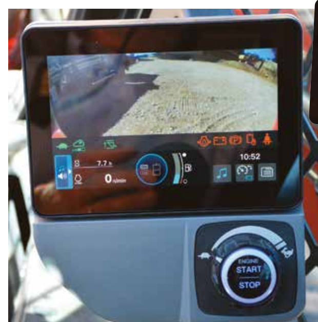
Più sicurezza con la retrocamera ad alta risoluzione di serie
