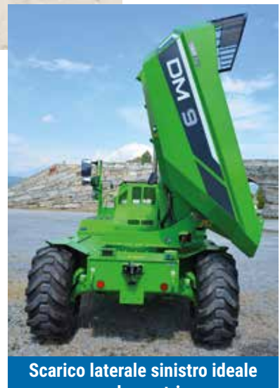
Scarico laterale sinistro ideale per colmare trincee
