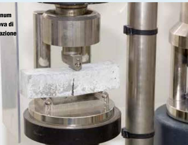
**Prova a flessione - Telaio 3**
