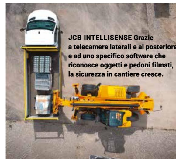
**JCB INTELLISENSE** Grazie a telecamere laterali e al posteriore e ad uno specifico software che riconosce oggetti e pedoni filmati, la sicurezza in cantiere cresce.
