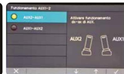
**INVERSIONE COMANDI** È possibile invertire i joystick di controllo delle linee Aux1 e Aux 2. Molto pratico.
