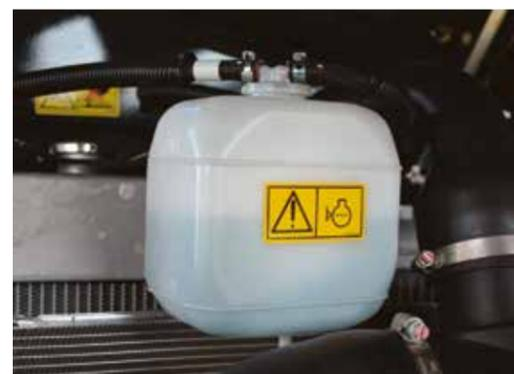
**PREVENIRE...** è meglio che rifare. La vasca di compensazione del refrigerante più alta di testa motore e radiatori permette all'elettronica di segnalare la temperatura elevata prima che sia troppo tardi.
