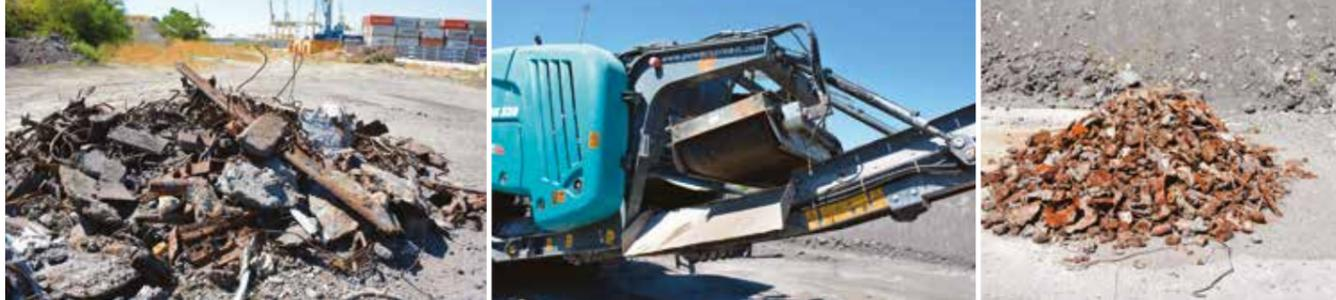
**PRIMA E DOPO** Sopra, in sequenza da sinistra, gli elementi ferrosi estratti a monte del frantoio, il deferizzatore del Powerscreen Premiertrak 330 e il ferro che ha intercettato dopo averlo «masticato» con le sue granitiche mascelle.
