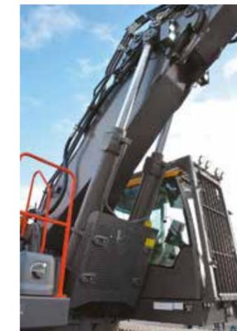
**CILINDRI MAGGIORATI** Per sollevare il braccio HR con estensione, sono stati montati cilindri di diametro superiore. L'assenza di tubazioni sui lati del braccio facilita il sollevamento con ancoraggio catene.
