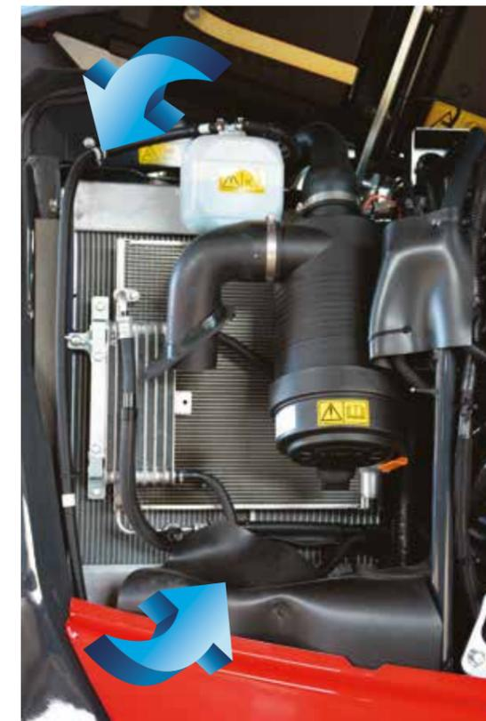
**VENTOLA È ORA ASPIRANTE** Gli scambiatori di refrigerante e olio idraulico sono tra loro affiancati, mentre in serie c'è il condensatore del climatizzatore automatico e lo scambiatore di calore per il gasolio. La ventola plastica è azionata da cinghia registrabile via alternatore.
