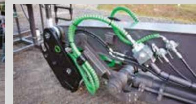
**3.500 MM** Anche l'EC500 HR può montare ora un'estensione lunga 3.500 mm per arrivare ad una altezza al perno benna di 32 m. Doppia telecamera in testa al braccio HR e layout tubazioni ottimizzato.
