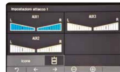
**REGOLAZIONE ASIMMETRICA** I flussi delle linee Aux 1, Aux 2 e Aux 3 si possono regolare destra/sinistra.
