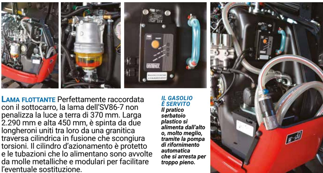
**LAMA FLOTTANTE** Perfettamente raccordata con il sottocarro, la lama dell'SV86-7 non penalizza la luce a terra di 370 mm. Larga 2.290 mm e alta 450 mm, è spinta da due longheroni uniti tra loro da una granitica traversa cilindrica in fusione che scongiura torsioni. Il cilindro d'azionamento è protetto e le tubazioni che lo alimentano sono avvolte da molle metalliche e modulari per facilitare l'eventuale sostituzione.
