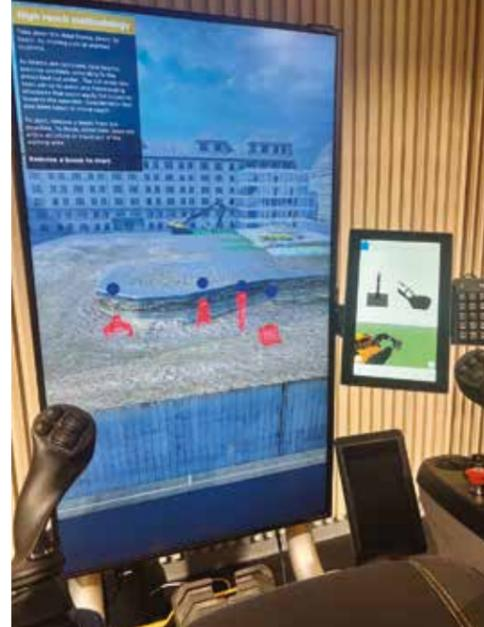
**TRE MONITOR** La cabina dei Serie F dedicata agli HR ha un terzo monitor alto per sistema Demolition Assist. A destra, il simulatore per macchine da demolizione.
