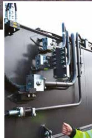
**SUPPORTI** Basta connessioni a penzolini. Nuovi supporti aiutano l'assemblaggio mantenendo i pesanti connettori perfettamente in linea.
