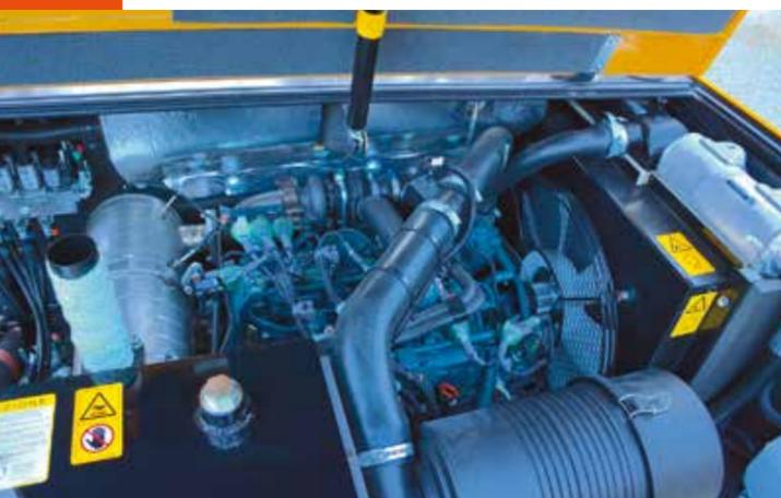
**IC37-5** Il dumper cingolato esposto a Monteriggioni (SI) è pronto per il mercato Europeo, forte di un motore quattro cilindri turbo Kubota da 3,3 litri. Il carico operativo di questo carrier cingolato è di 3.700 kg.
