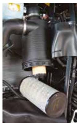
**EGR ELETTRONICO** Sullo Yanmar 4TNV98CT il ricircolo dei gas di scarico è esterno e raffreddato. Grazie al controllo elettronico della valvola attuatrice via ECU, il ricircolo non è continuo, ma avviene solo quando necessario, ottimizzando la combustione, quindi l'efficienza. Il filtro aria è un Donaldson di dimensioni generose.
