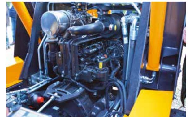
**SOTTOPELLE** Il motore è montato in linea con calettate le pompe idrauliche, il blocco scambiatori è apribile a libro per favorire la pulizia, le componenti del sottocarro cingolato sono dell'italiana Berco.
