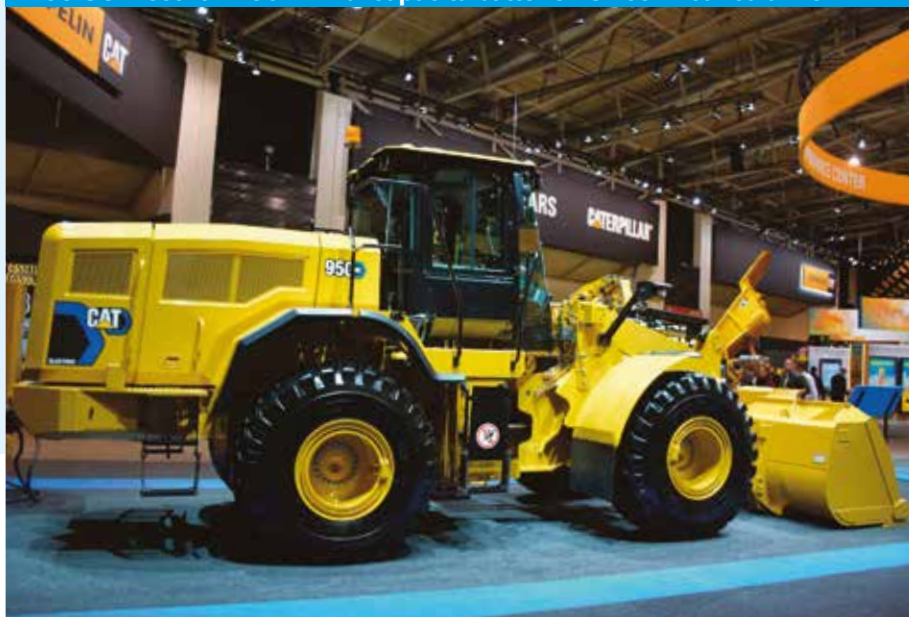
950 GC Electric - 256 kWh di capacità batterie - 8h con ricarica di 45 min
