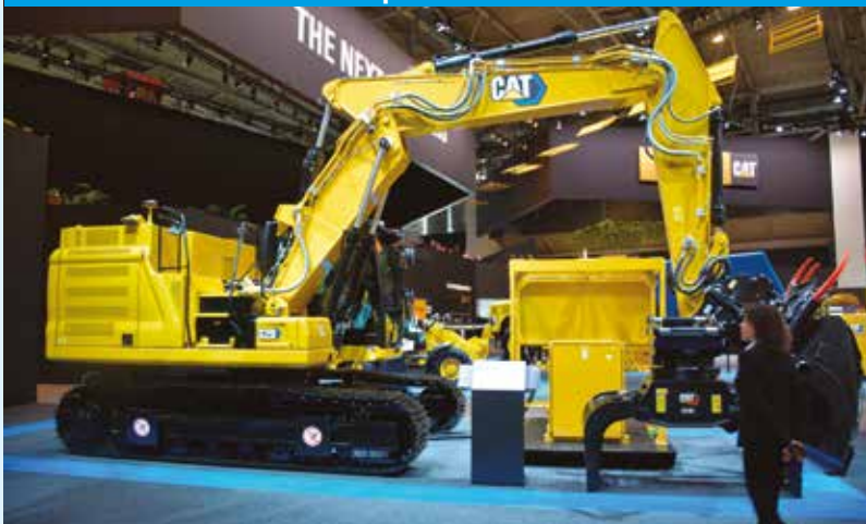
320 Electric - 387 kWh di capacità batterie - autonomia 8h
