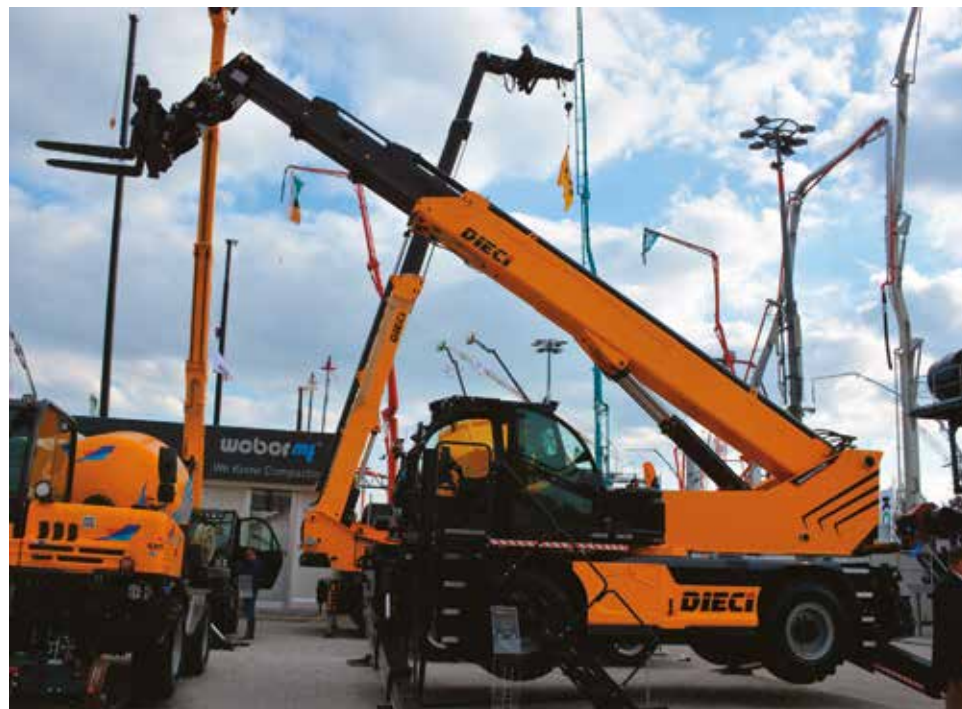
PEGASUS 100.29 Grande novità per Dieci che presenta la sua nuova ammiraglia della gamma di sollevatori telescopici rotativi. Qui a sinistra il nuovo Pegasus 100.29 da 10.000 kg di capacità massima, 28,6 m d'altezza massima alle forche, peso operativo di 24.000 kg e motore FPT da 147 kW di potenza.
