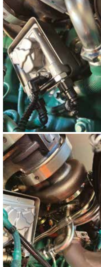
RICIRCOLO GAS A CONTROLLO ELETTRONICO
