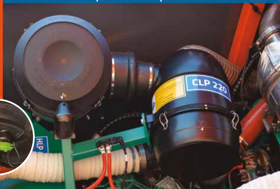
Filtro aria a bagno d'olio con sensore d'intasamento per ambienti molto polverosi
