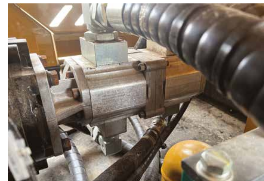
Pompa per carica dell'idrostatico e pompa per cassone e rotazione in serie
