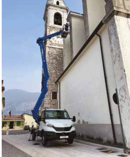
NUOVA B-LIFT 18 HD In basso, una foto della nuova telescopica con portata di 300 Kg in cesta, stabilizzatori verticali, disponibile su Daily a gasolio o elettrico.
