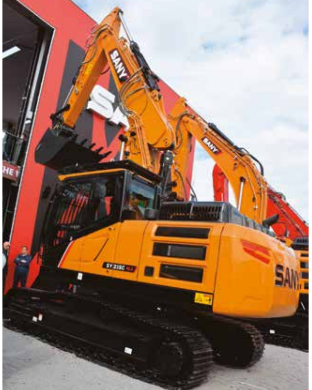
SY215C NLC 2PB - pesa 24 tonnellate, gli mancano i doppia costola. La versione elettrica ha il carro largo 2.980 mm
