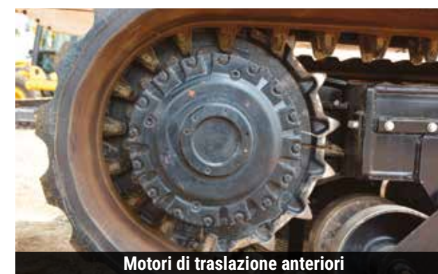
Dentatura sostituibile (4 sezioni)
