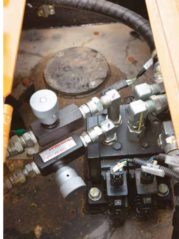
Regolazione fine della rotazione da fabbrica... da non toccare!
