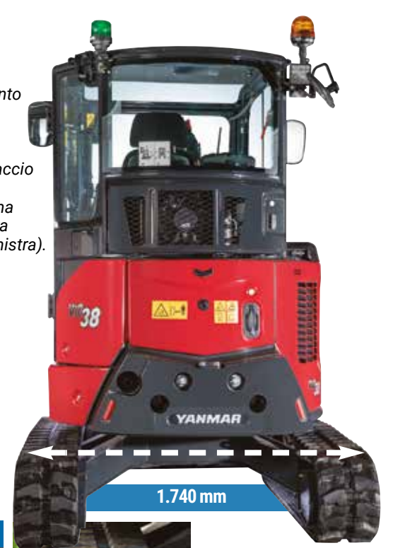
ANCHE IN FERRO I cingoli da 300 mm di larghezza sono disponibili anche in acciaio. A questi, si possono poi montare dei sovracingoli in gomma. Così sale il peso, ma ci guadagna anche la stabilità.
