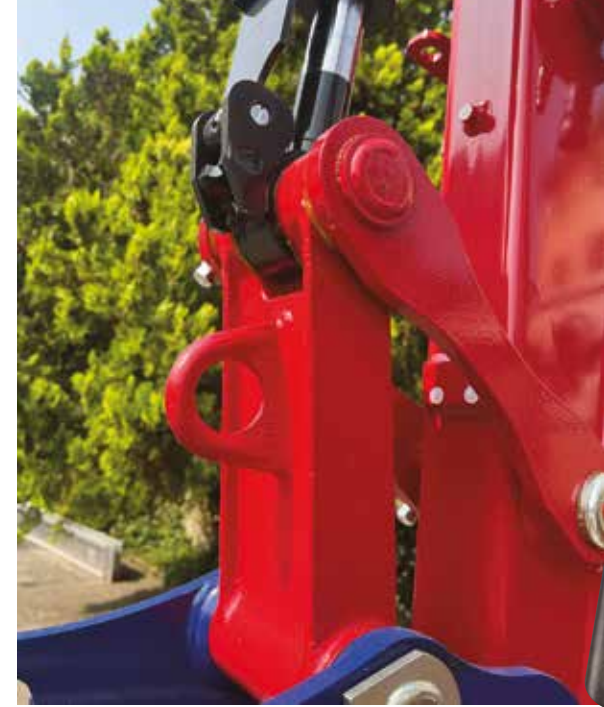
3 VALVOLE DI SERIE Il cosiddetto kit sollevamento è di serie. Le valvole di sicurezza sono posizionate sui cilindri di sollevamento e avambraccio e su quello della lama. La piastra di richiamo benna realizzata in fusione integra un anello chiuso (foto a sinistra).
