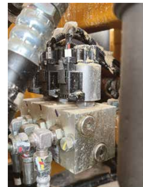
Elettrovalvole cambio velocità, freno parcheggio, freno rotazione
