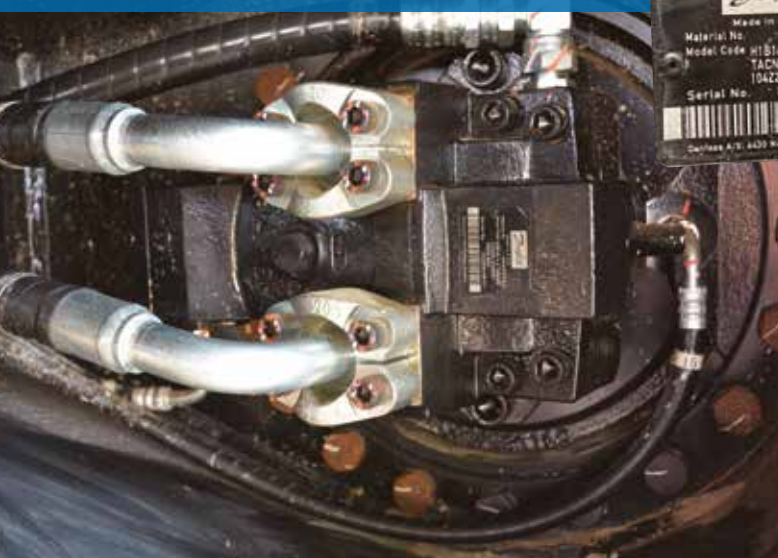
Motori di traslazione Danfoss HB160
