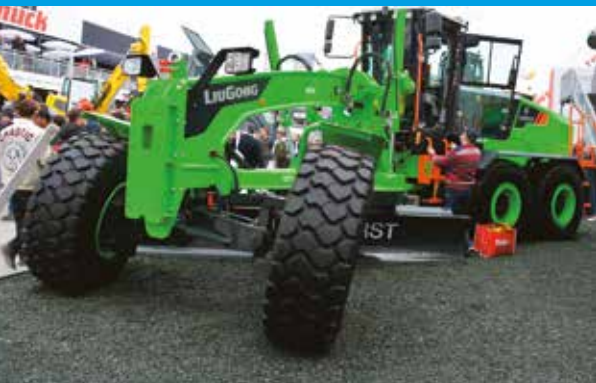
GRADER 4280DE - BATTERIA LFP DA 423 KWH - AUTONOMIA 6-8 ORE
