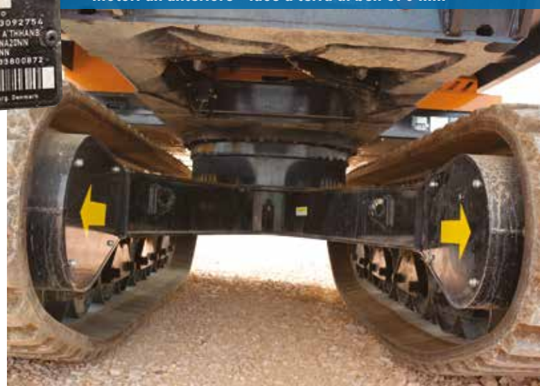
Motori all'anteriore - luce a terra di ben 570 mm
