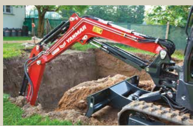
DETTAGLI Sopra le tubazioni modulari della lama. Cambiarle non è mission impossibile.
