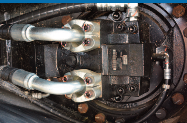
Motori di traslazione Danfoss H1B210
