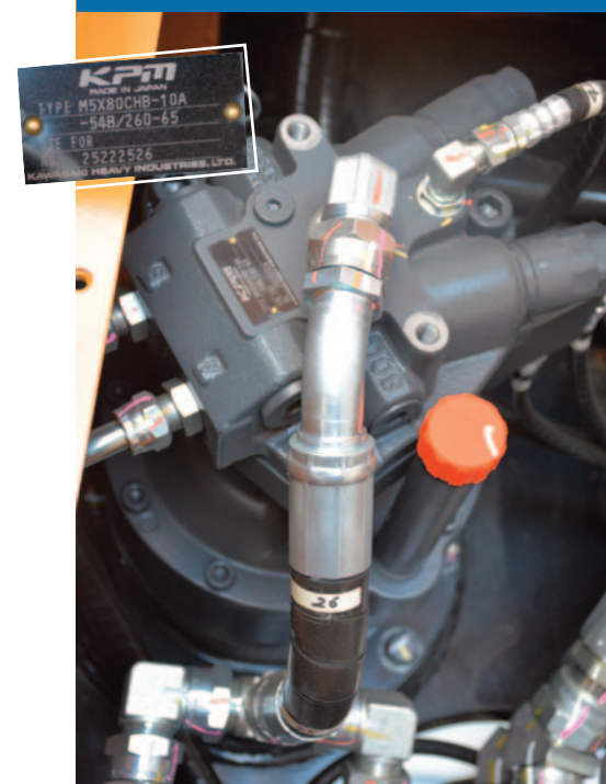
Motore di rotazione Kawasaki
