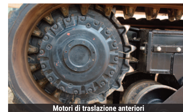
Ruota traslazione in 4 sezioni (sostituibili)
