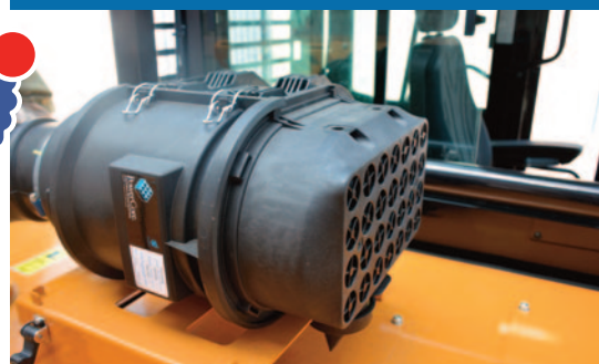
Filtro aria microciclonico PowerCore
