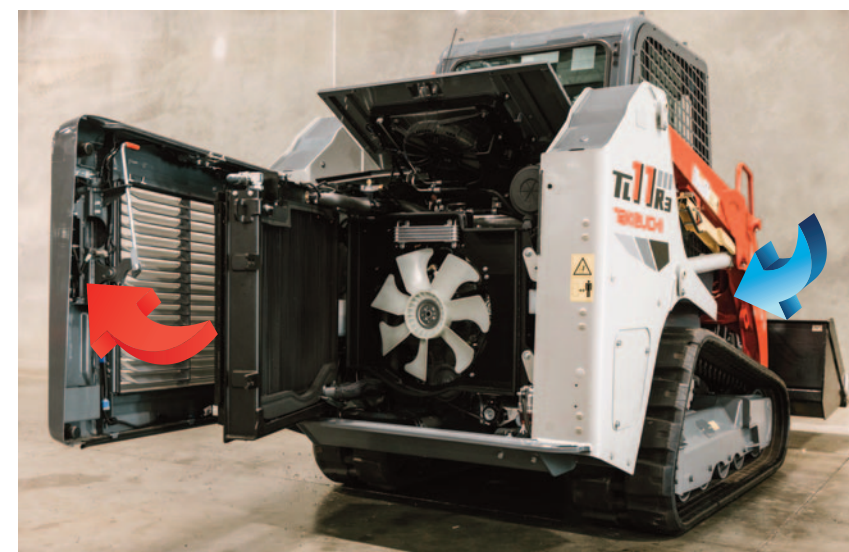
Ventola condensatore elettrica
