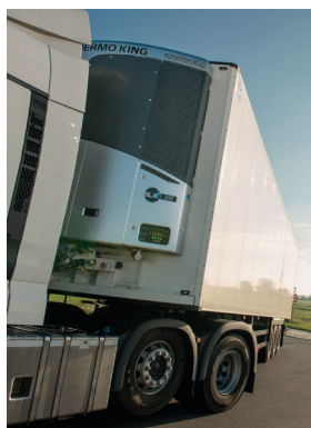
Un semirimorchio provvisto di unità di refrigerazione SLXi prodotta da Thermo King.
