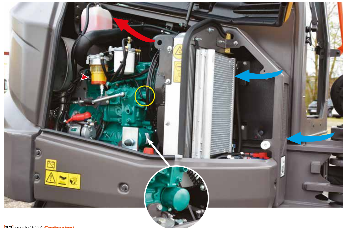
Il motore è sospeso su supporti elastici di notevoli dimensioni per ridurre al massimo le vibrazioni.
