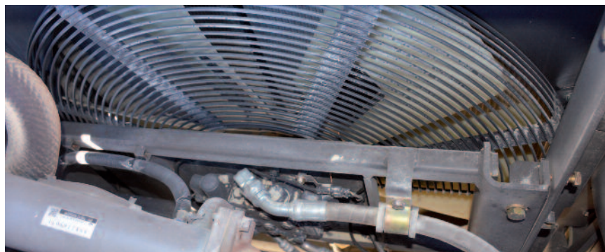
SCAMBIATORI DI OLIO E REFRIGERANTE SOSPESI E PARALLELI
