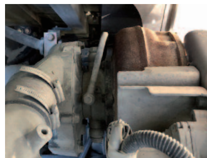
Turbo a geometria variabile con maxi intercooler
