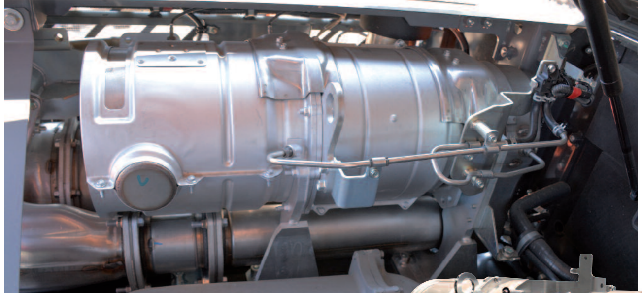
DOC 1 + CSF (antiparticolato) + iniezione di urea + SCR 1 + SCR 2 + DOC 2
