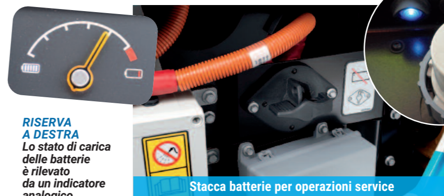
SPIA BLU O VERDE Difficile capire a orecchio se il JCB 19C-1E sia acceso o meno. Lo si capisce grazie a una spia blu su console e vicino alla presa di ricarica. In fase di ricarica la luce diventa verde.
