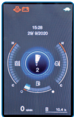
In home: il regime motore, la temperatura refrigerante, livello gasolio e attrezzatura.
