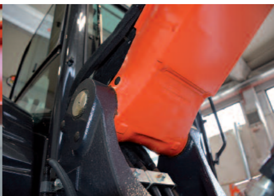
BASE BRACCIO IN FUSIONE. BRACCIO IDENTICO AL KX60-5, MA AVAMBRACCIO PIÙ CORTO DI 185 MM
