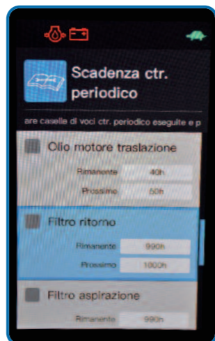
...filtro gasolio, filtro olio e filtro olio idraulico, filtro del ritorno olio, dei pilotaggi...
