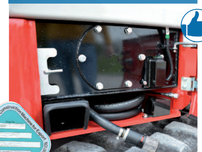
Serbatoio olio in metallo con filtro in alimentazione e ritorno
