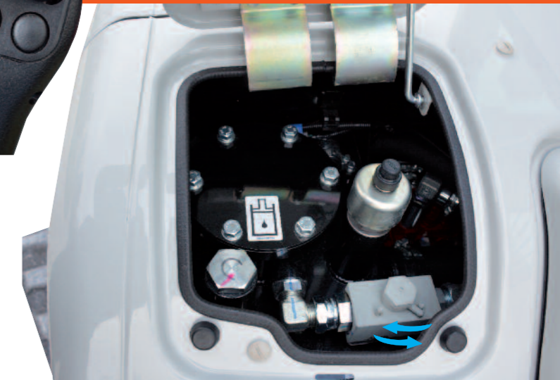
Serbatoio olio in metallo con filtro in alimentazione e ritorno
