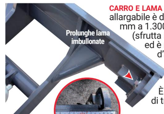
**CARRO E LAMA ALLARGABILI** Il carro allargabile è di serie. Passa da 980 mm a 1.300 mm idraulicamente (sfrutta il circuito lama) ed è realizzato a regola d'arte. Tutte le tubazioni sono protette e rivestite al 100% con spirali metalliche. È predisposto un gancio di traino/ancoraggio.
