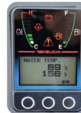
**TEMPERATURA MOTORE** Il refrigerante è monitorato con i led sulla parte sinistra del cruscotto e la temperatura si può visualizzare sull'lcd.
