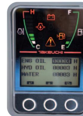
**MANUTENZIONE** La progressione delle ore operative è resettabile per tre parametri: olio motore, idraulico e refrigerante.
