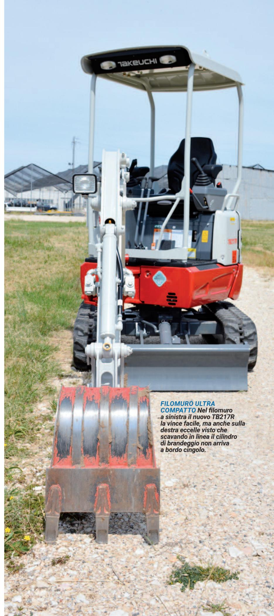
**FILOMURO ULTRA COMPATTO** Nel filomuro a sinistra il nuovo TB217R la vince facile, ma anche sulla destra eccelle visto che scavando in linea il cilindro di brandeggio non arriva a bordo cingolo.
