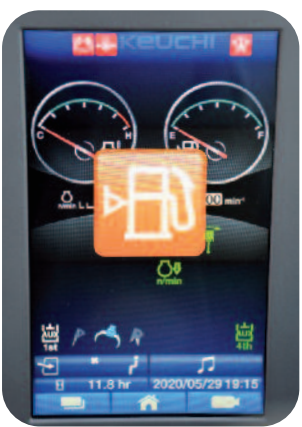
ALERT EVIDENTI Il sistema prevede differenti icone e segnali d'allerta. Arancione è un pre allarme, rosso è segnale d'allarme.
