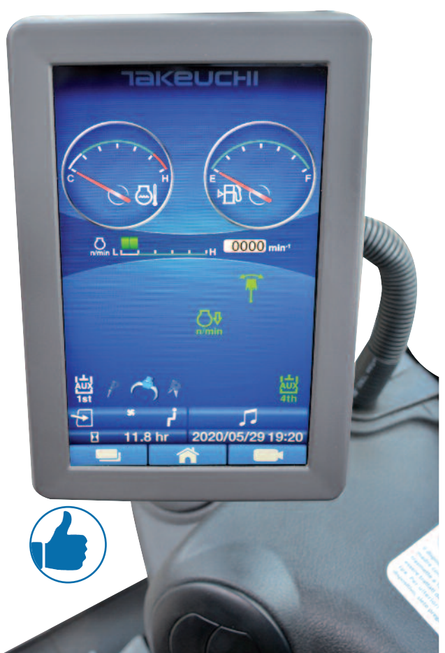
DOPPIA SICUREZZA La macchina è dotata di chiave con immobilizer, ma si può anche impostare una password a monitor.
