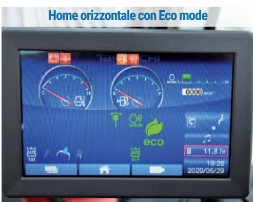
AUX 1 AL MASSIMO Qui è rappresentata la portata massima di aux 1 per una attrezzatura a singolo effetto.
