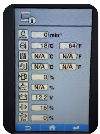
VISTA SUI SENSORI È possibile rilevare in tempo reale i dati dei sensori di livello e temperatura, senza connettersi alla presa OBD.
