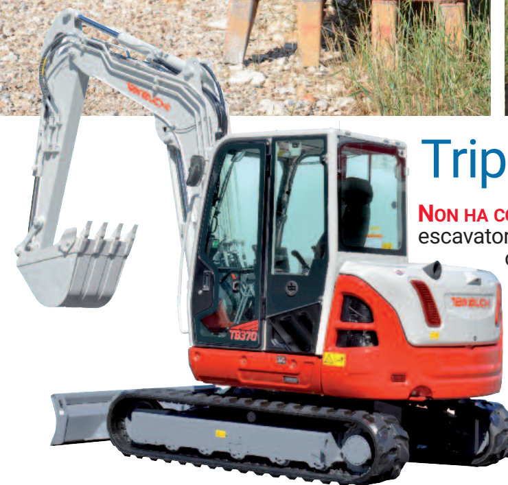
1.455 O 1.480 MM Lo sbalzo posteriore della torretta è di 1.455 mm ma scegliendo la zavorra maggiorata di 95 kg lo sbalzo aumenta fino a 1.480 mm
