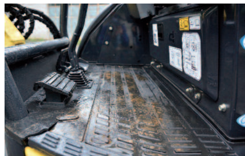
ANTISCIVOLO ETERNO Per essere un mini ha un bello spazio per i piedi, anche grazie al pavimento piatto (predisposizione al montaggio pedali). La soglia d'ingresso è realizzata in fusione, ha un buon grip e non si consuma.
