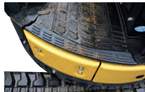
ANTISCIVOLO ETERNO Per essere un mini ha un bello spazio per i piedi, anche grazie al pavimento piatto (predisposizione al montaggio pedali). La soglia d'ingresso è realizzata in fusione, ha un buon grip e non si consuma.
