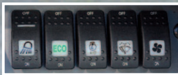
2 TASTI IN PIÙ La versione cabina ha anche i pulsanti per ventola e tergicristallo.
