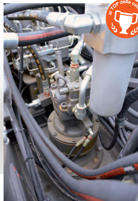
Distributore a centro aperto ma con positive control elettronico
