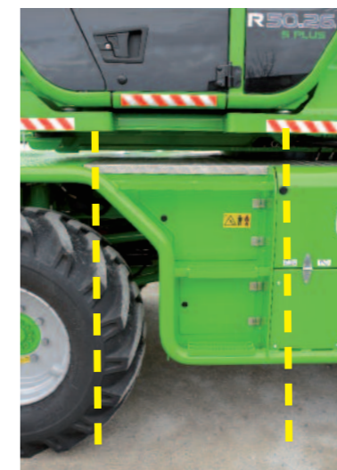
Regolazione manuale degli stabilizzatori
