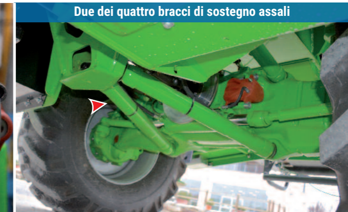
Assali made in Merlo con freni centrali e interni
