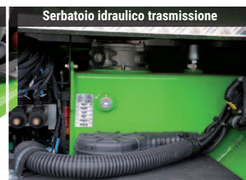
IL MOTORE AZIONA 2 POMPE A PORTATA VARIABILE, UNA DEDICATA ALLA TRASMISSIONE E UNA AI SERVIZI
