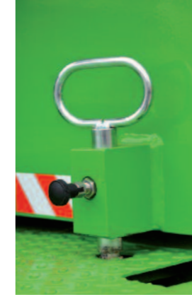
Solo 95 mm oltre l'estensione degli stabilizzatori
