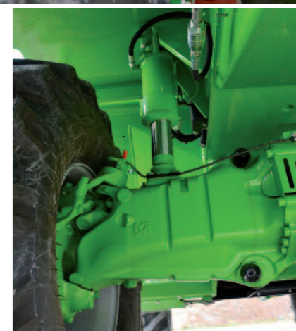
Assetto variabile con sospensioni idro pneumatiche
