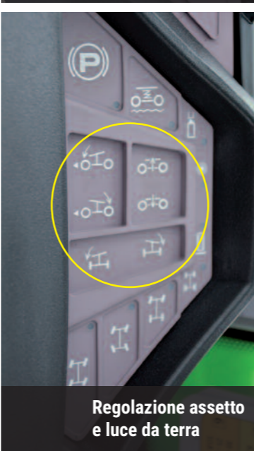
Regolazione manuale degli stabilizzatori
