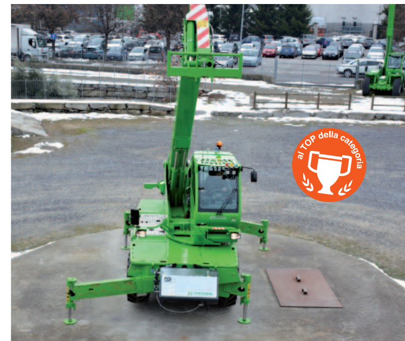
Stabilizzatori totalmente indipendenti
