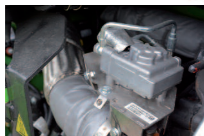
Valvola allo scarico per ottimizzare ed elevare le temperature
