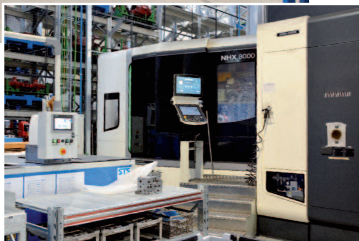
In alto, una piegatrice di lamierati totalmente automatizzata che può lavorare 24 ore su 24. Qui sopra, una delle nuove fresatrici per rifinire le fusioni.
