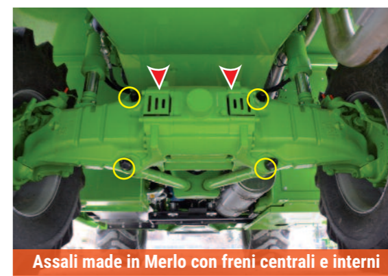
Due dei quattro bracci di sostegno assali
