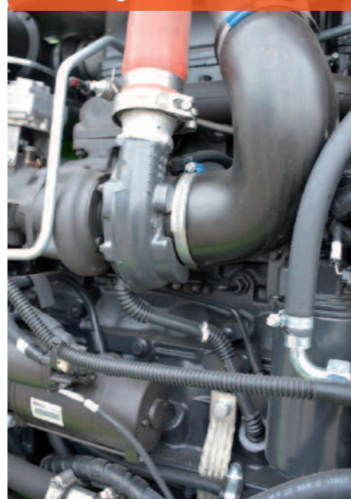
Valvola allo scarico per ottimizzare ed elevare le temperature
