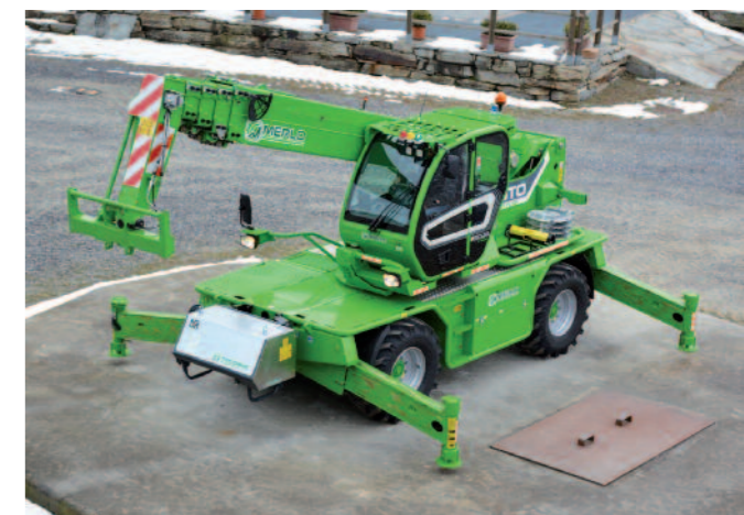
Stabilizzatori totalmente indipendenti
