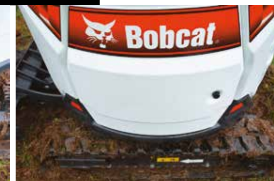
Carro e lama allargabili da 980 a 1.360 mm
