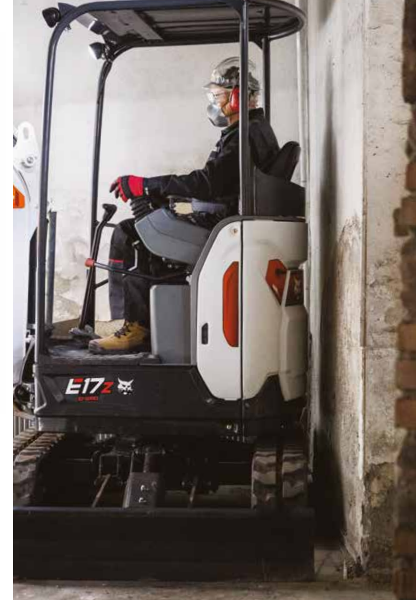
Cingoli sempre da 230 mm ma di nuovo disegno
