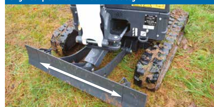
Carro e lama allargabili da 980 a 1.360 mm
