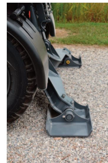
I cilindri di sollevamento lama e stabilizzatori sono identici e tutti dotati di valvola anticaduta di serie
