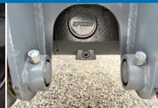
Assale Dana Spicer anteriore è oscillante +/- 6° bloccabile
