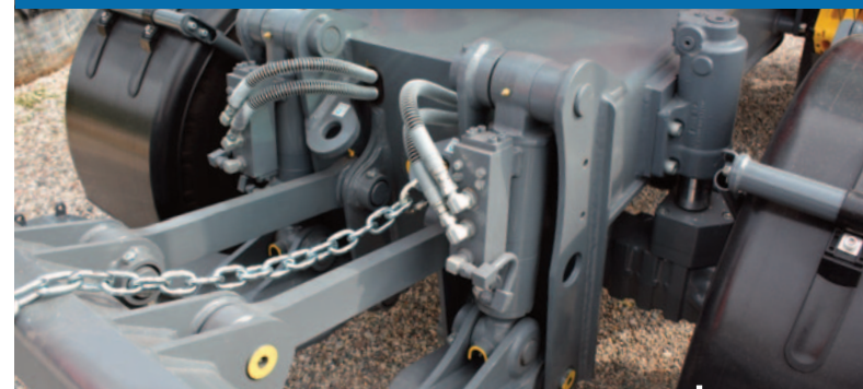
Assale Dana Spicer anteriore è oscillante +/- 6° bloccabile
