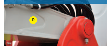
Rinforzi alla base del braccio
