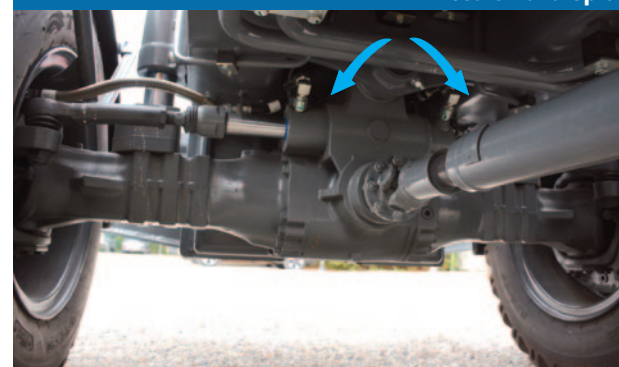
Assale Dana Spicer anteriore è oscillante +/- 6° bloccabile
