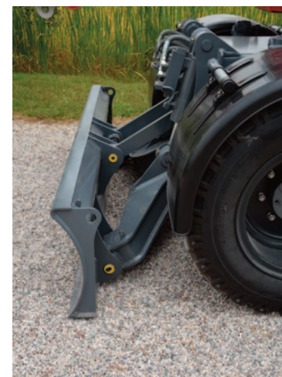
I cilindri di sollevamento lama e stabilizzatori sono identici e tutti dotati di valvola anticaduta di serie
