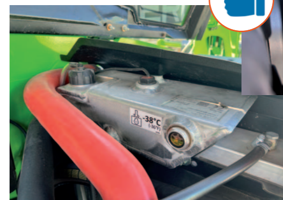
Vasca compensazione più alta di testa motore e culmine radiatore
