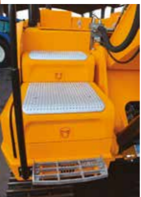
Piano torretta antiscivolo e removibile
