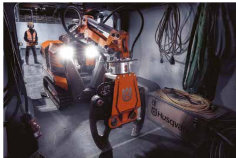
LEGGERO Con un peso operativo di circa 500 kg il DXR95 «vola» sulle solette e si carica in un furgone patente B senza alcun problema.
