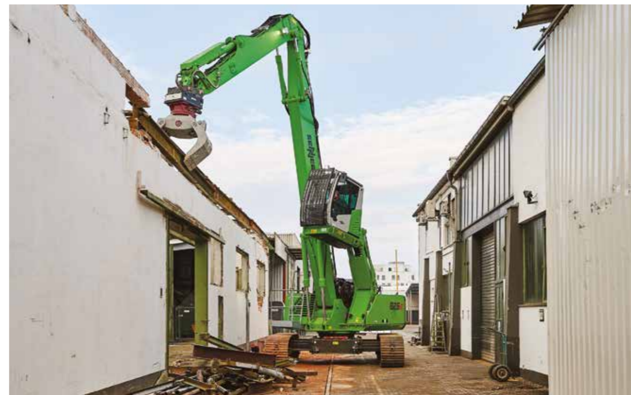
CABINA ELEVABILE L'825 E Demolition permette sia di inclinare la cabina, sia di alzarla a 2,7 metri.
