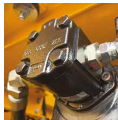
PILOTAGGI Sopra la pompa pilotaggi KPM e sotto il relativo filtro (10 micron), molto ben accessibile da terra.
