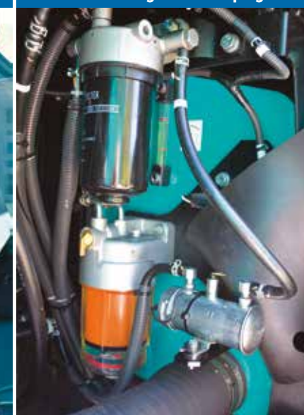
Decantatore gasolio con spurgo
