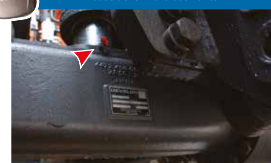
Nuovo ingrassatore alla base del cilindro oscillante
