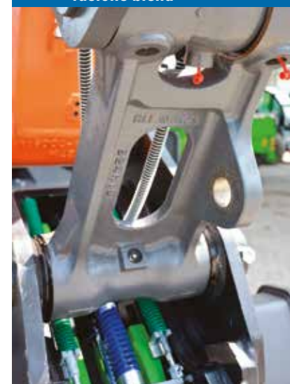
Anello parte della fusione biella
