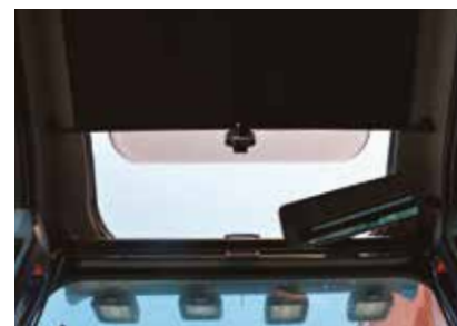
Nuova protezione alla base del braccio tergicristallo
