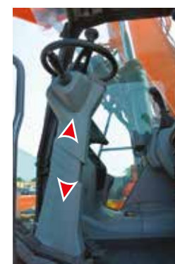
DOPPIA SPAZZOLA Il pantografo ha una piccola spazzola inferiore per pulire il vetro basso: visibilità. Soluzione ai vertici della categoria.
