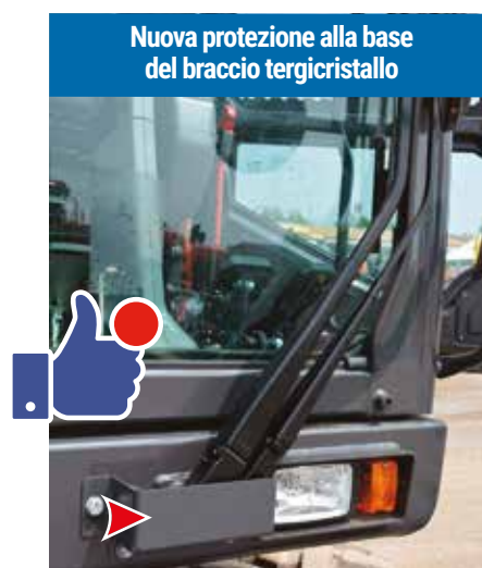
DOPPIA SPAZZOLA Il pantografo ha una piccola spazzola inferiore per pulire il vetro basso: visibilità. Soluzione ai vertici della categoria.
