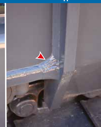
Saldature robotizzate sovrapposte di rinforzo
