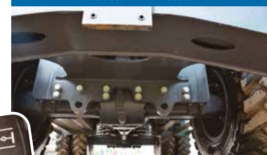
Nuovo ingrassatore alla base del cilindro oscillante
