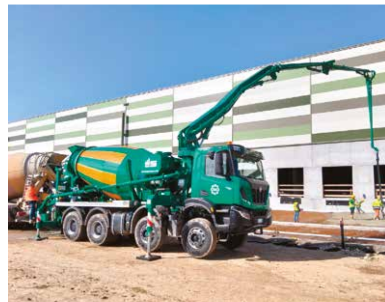
TWINSTAR 4Z32 Sopra l'autobetonpompa Sermac top di gamma con braccio da 32 metri in quattro sezioni. A sinistra, la macchina al lavoro con braccio completamente aperto, a destra in assetto stradale.
