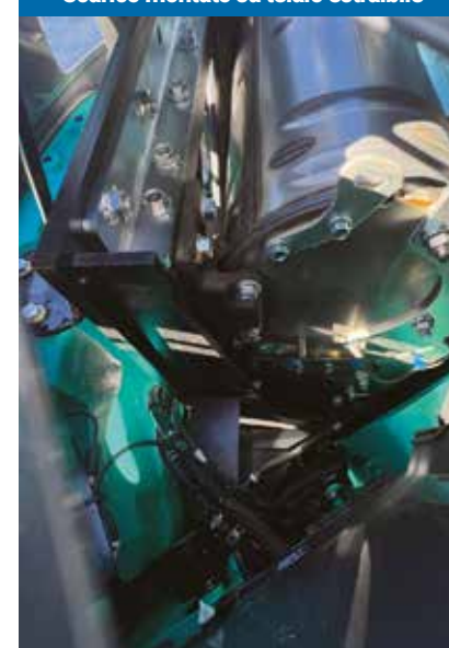
Scarico montato su telaio estraibile
