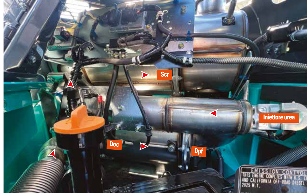
Iniettore di urea Bosch in posizione ben ventilata
