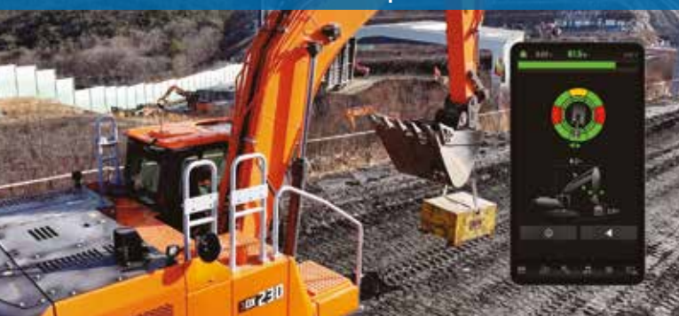
Lift assist che indica la capacità residua
