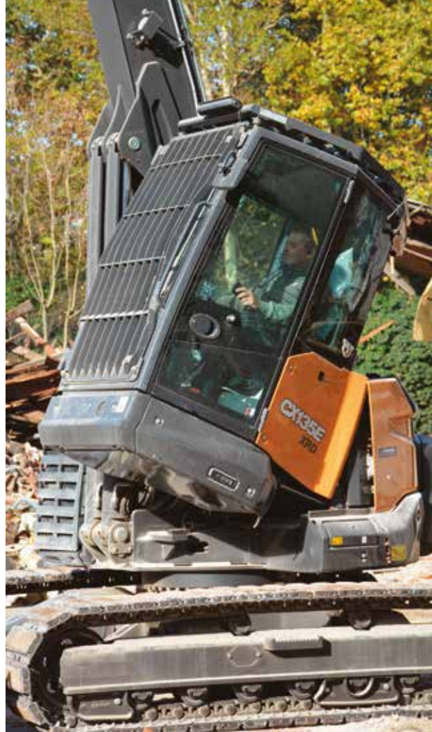
COME I GRANDI Uno dei fiori all'occhiello del CX135E XRD è sicuramente la cabina pressurizzata, ampia, confortevole, climatizzata e soprattutto tiltabile di 30°!
