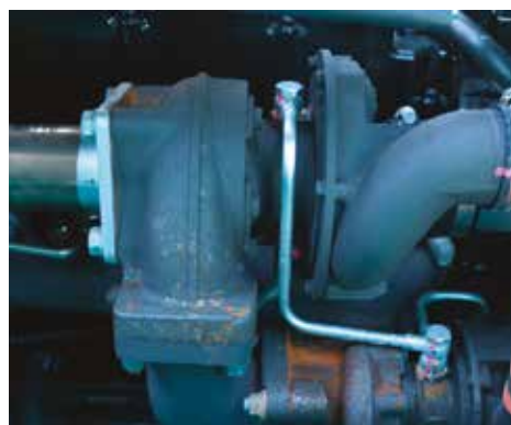
Prima turbina con wastegate
