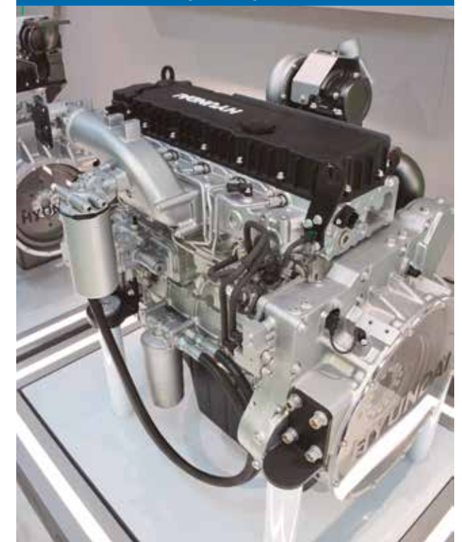
fino a 350 kW di potenza per il 6 cilindri HX08
