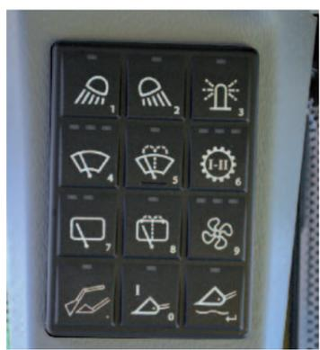
**SMART** Una pratica pulsantiera antipolvere retroilluminata permette di gestire rapidamente luci, tergicristalli, parallelismo benna e l'azionamento del flottante.
