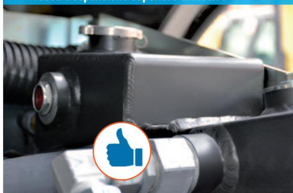
**AFFIDABILITÀ** La porzione dello scambiatore dedicata al refrigerante ha in testa una vasca d'espansione con oblo e un sensore di livello per proteggere il motore prevenendo surriscaldamenti.
