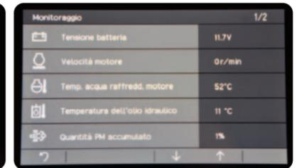
**PARAMETRI VITALI** Si «vede» tutto, dalla tensione batteria, alla temperatura di refrigerante motore e olio idraulico.
