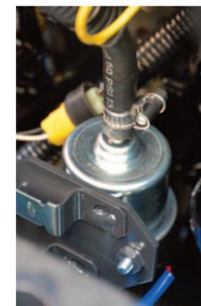
**GASOLIO** Il bocchettone del gasolio è ben accessibile da terra, protetto da uno sportello con chiave. Il filtro per trattenere le impurità è molto profondo per permettere rifornimenti più veloci. In caso si svuoti il decantatore del gasolio da impurità il reinnescimento dell'impianto è elettro assistito. Veloce e pratico.
