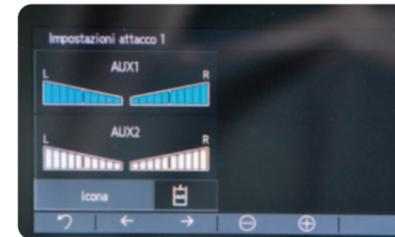
**REGOLAZIONE ASIMMETRICA** I flussi delle linee Aux 1, Aux 2 si possono regolare anche in modo asimmetrico.
