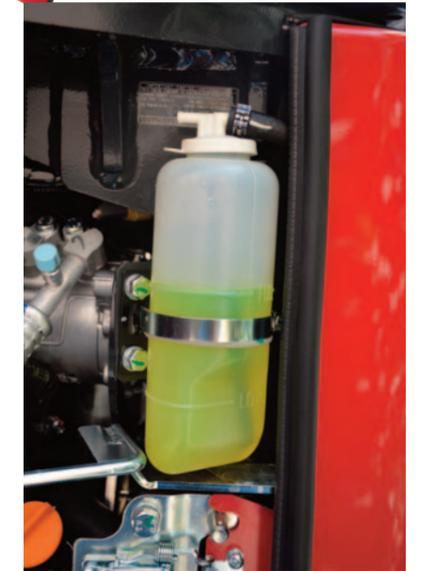
**VASO D'ESPANSIONE** La sua posizione alta permette una lettura reale del livello del liquido, ma anche di intercettare per tempo eventuali surriscaldamenti. Perfetto.
