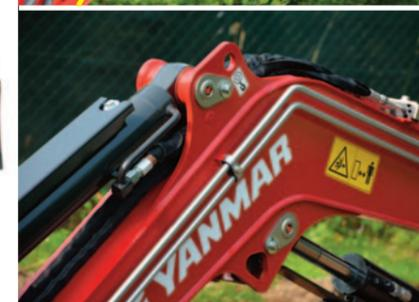
**INGRASSAGGIO FACILE** I punti per ingrassare le boccole dei cilindri sono tutti ben protetti.
