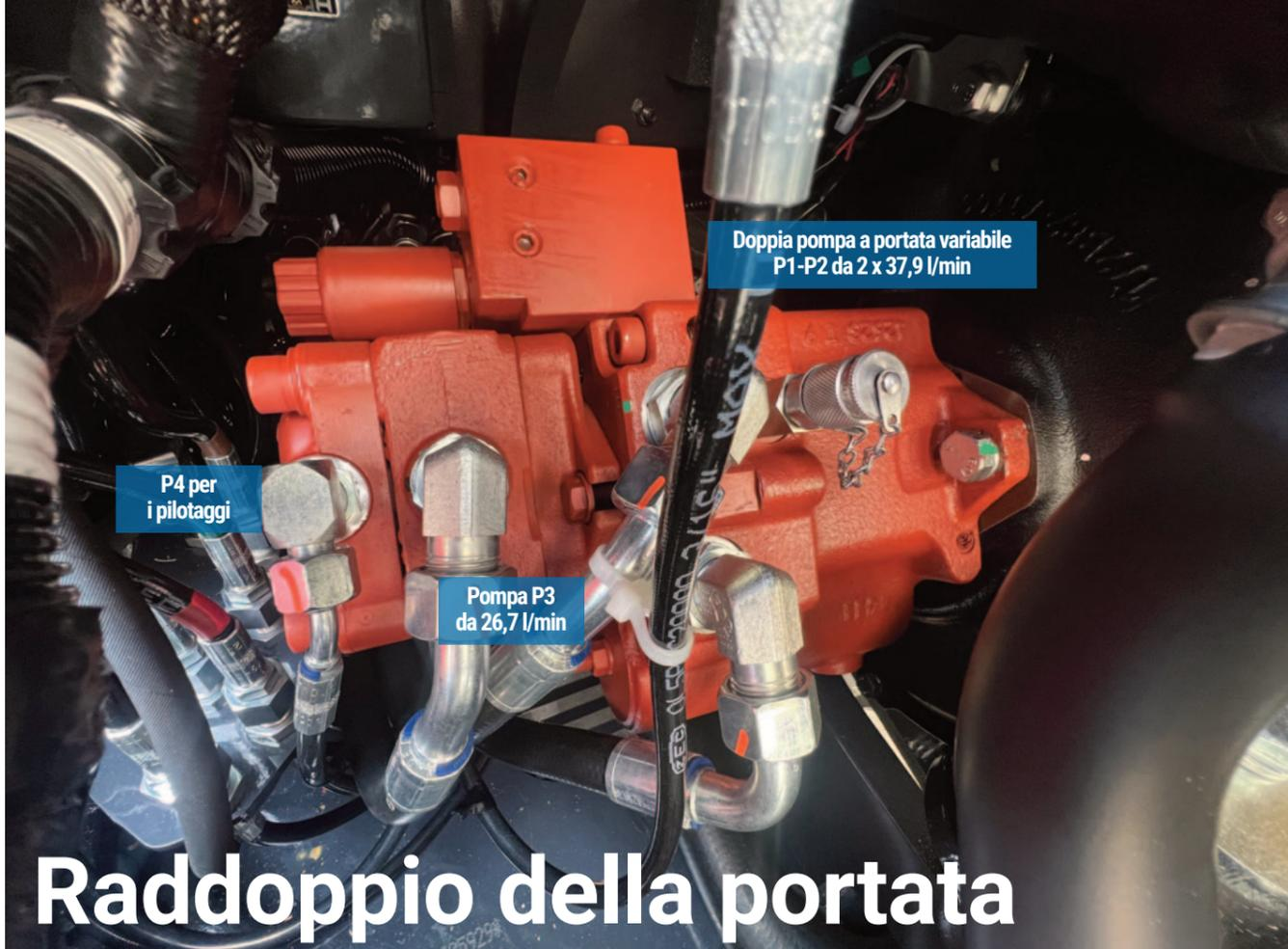
Doppia pompa a portata variabile P1-P2 da 2 x 37,9 l/min
