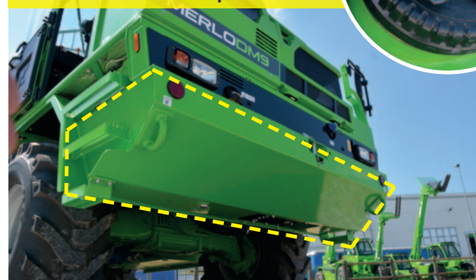
Serbatoio gasolio nella traversa frontale Abbassa il baricentro e compensa il carico
