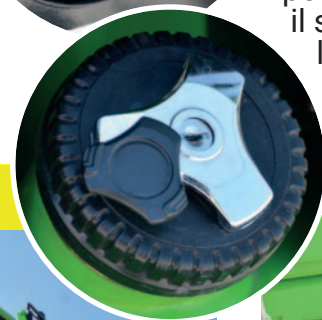
Serbatoio gasolio nella traversa frontale Abbassa il baricentro e compensa il carico
