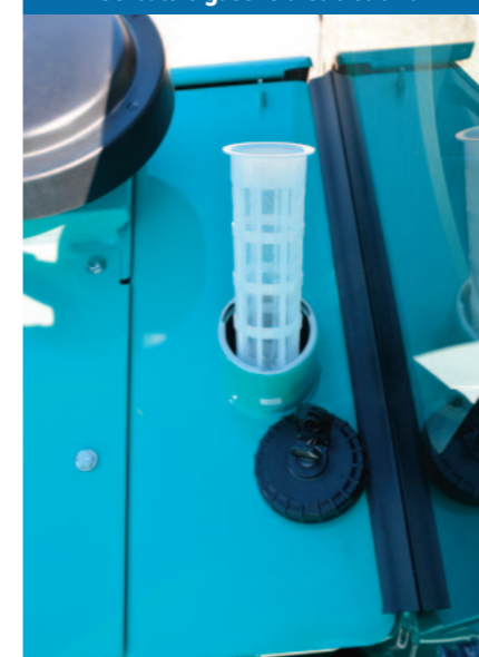
Serbatoio gasolio dietro cabina
