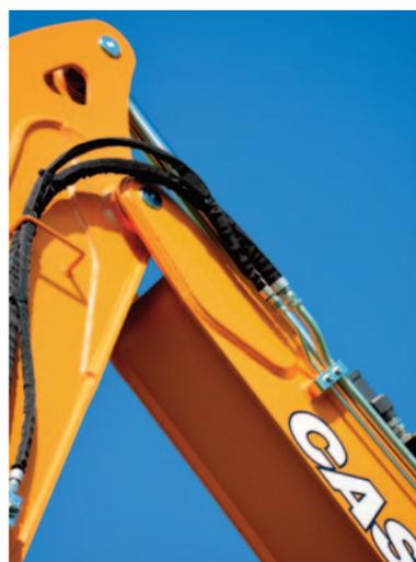
**PROTEZIONI E RINFORZI** Il braccio del CX100E è molto curato in ogni elemento. I cilindri inferiori hanno protezioni.
