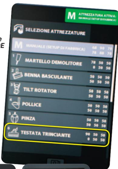
**PREIMPOSTATE** Il software ha preimpostate delle tipologie di attrezzature con dei setup preimpostati per semplificare l'accoppiamento con la macchina, velocizzarlo e scongiurare errori. Ogni parametro può essere poi modificato in base alle esigenze.
