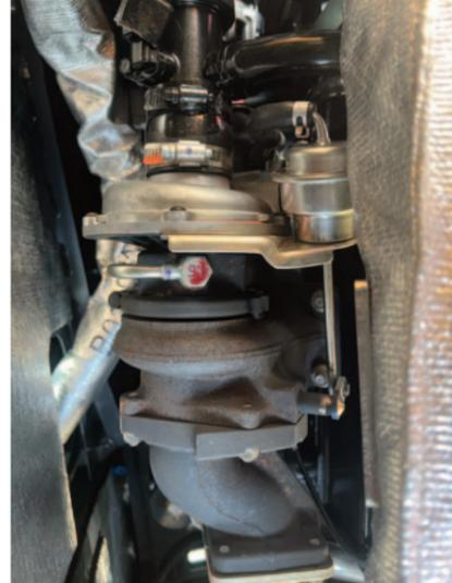
**GEOMETRIA FISSA** Il quattro cilindri da 3,3 litri Yanmar è sovralimentato con una turbina dotata di valvola wastegate per evitare picchi di pressione che potrebbero danneggiare la girante.
