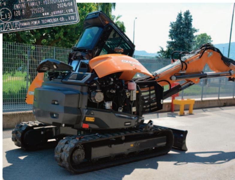
**MOTORE LATERALE** La scelta del motore montato a fianco della cabina permette al CX100E di essere un vero girosagoma (senza zavorra aggiuntiva) e semplifica la manutenzione ordinaria.
